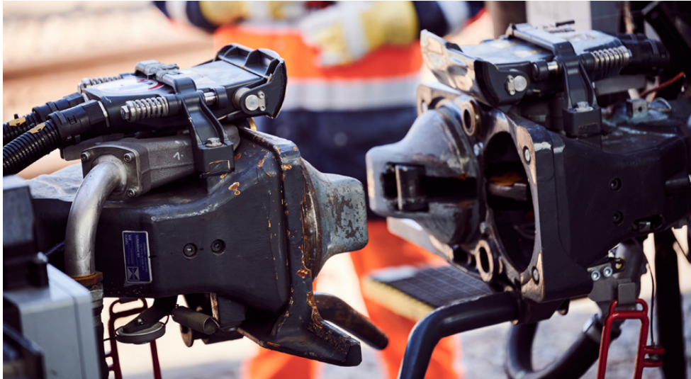
Abbildung 2: Digitale automatische Kupplung (DAK) © ÖBB
