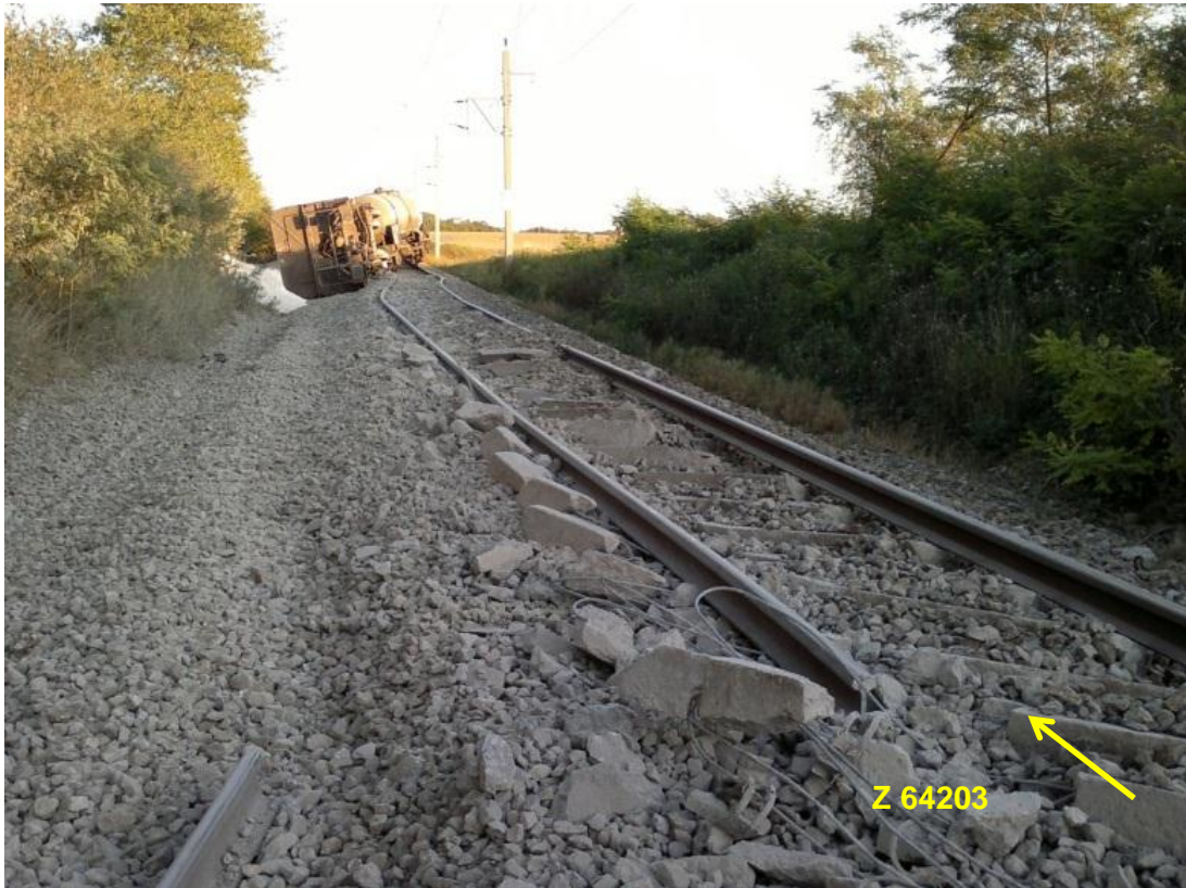
Abbildung 28 Entgleisungsfolgen ca. 300 m nach der Entgleisungsstelle - Quelle RU
