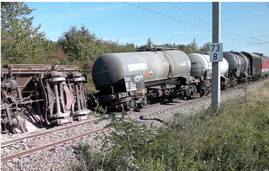
Abbildung 8 Entgleister vierter Wagen - Quelle RU
