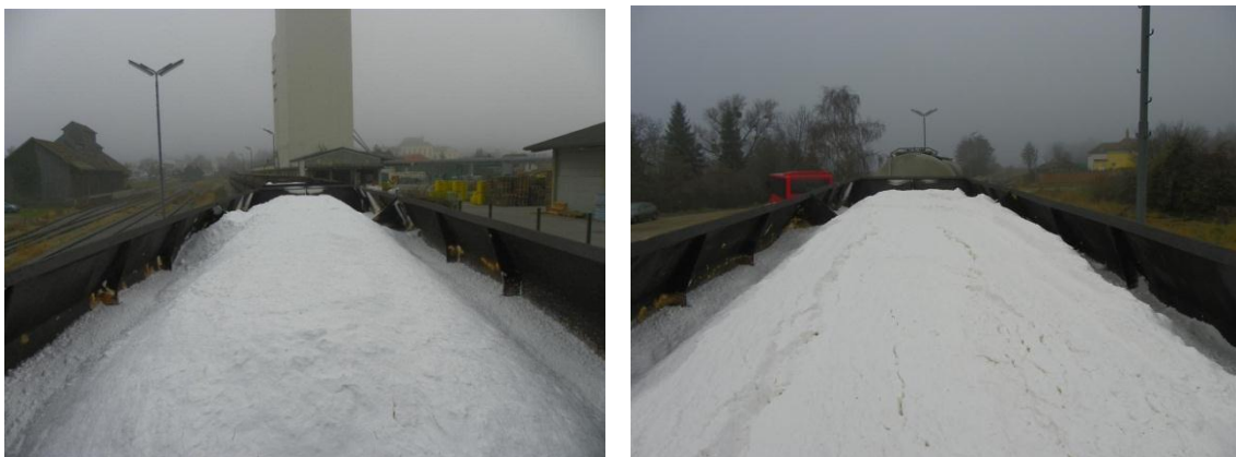
Abbildung 14 Beispiele der Beladung der Wagen mit Gips - Quelle RU
