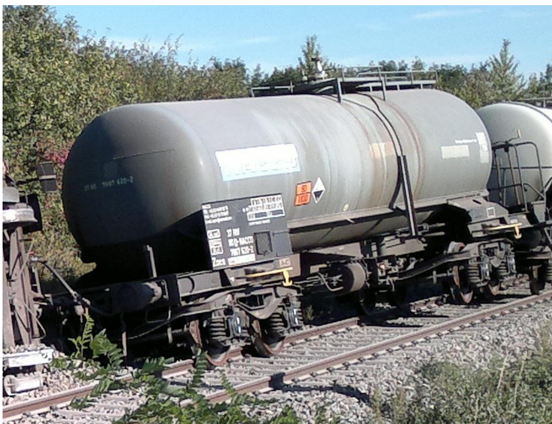
Abbildung 11 Entgleister Kesselwagen - Quelle RU
