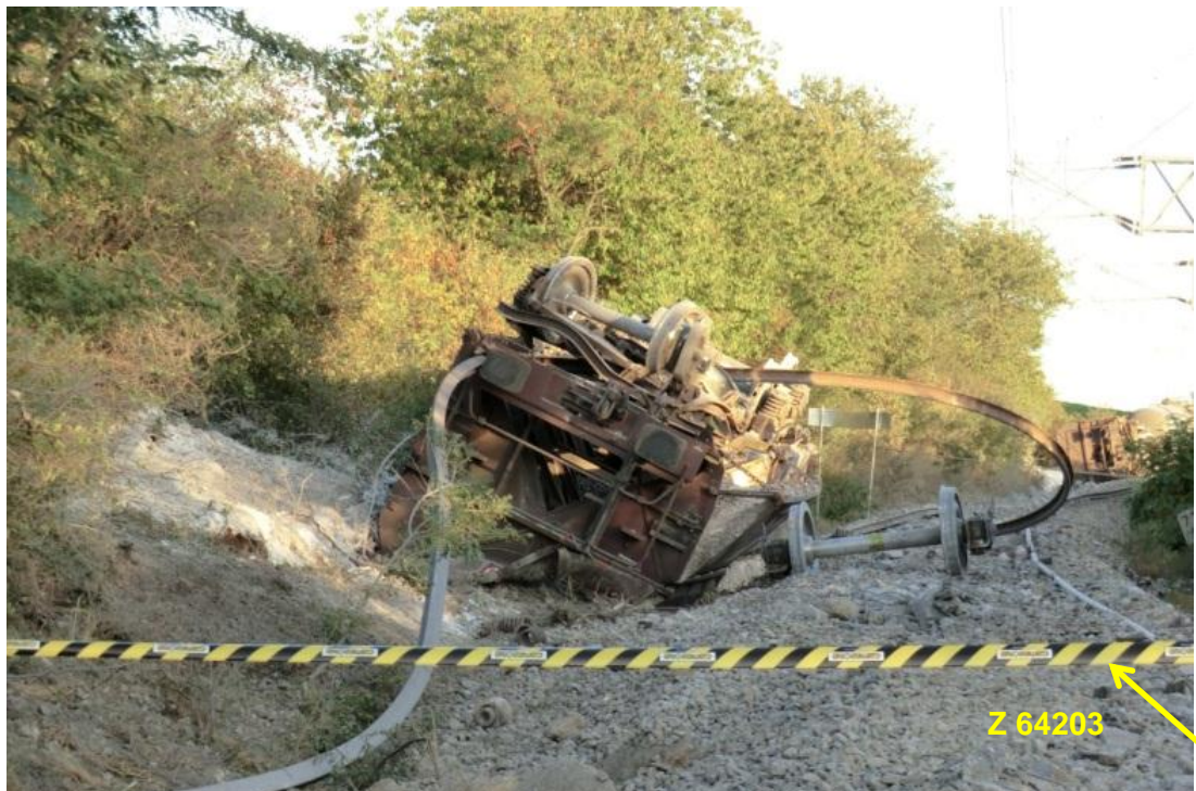
Abbildung 26 Entgleisungsfolgen ca. 170 m nach der Entgleisungsstelle und umge- stürzter sechster Wagen von Z 64203 - Quelle RU
