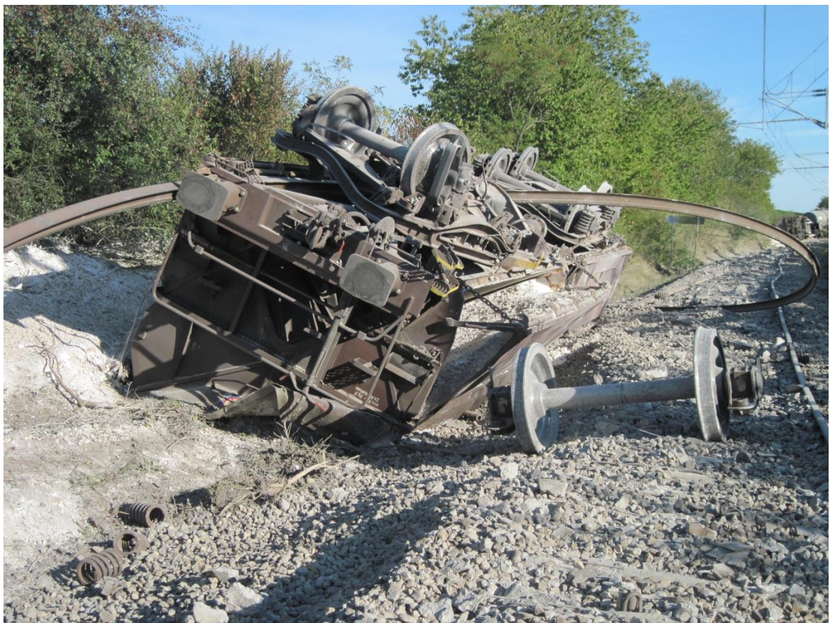
Abbildung 6 Entgleister sechster Wagen - Quelle IM
