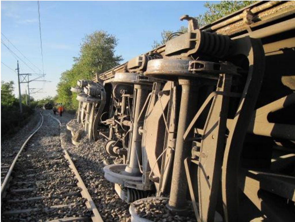
Abbildung 7 Entgleister fünfter Wagen - Quelle RU
