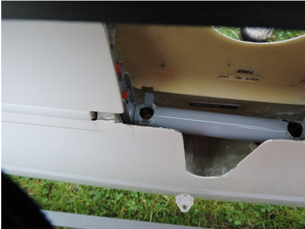
Abb. 4: eingerissene Öse der Höhenrudderlenkungswelle (Quelle SUB)
