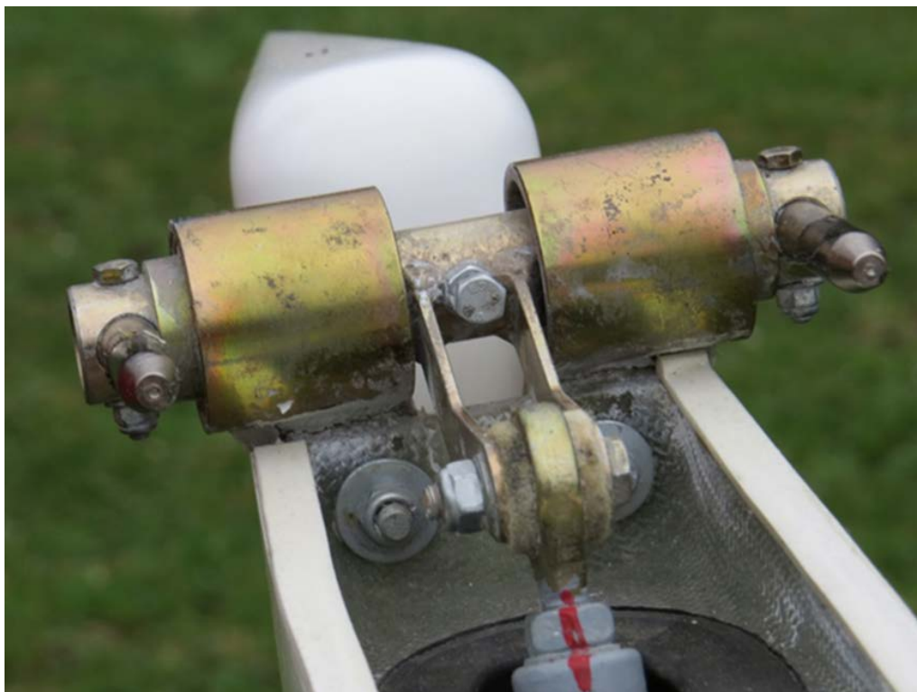
Abb. 5: eingerissene Befestigungen des Höhenrudderquadranten (Quelle SUB)
