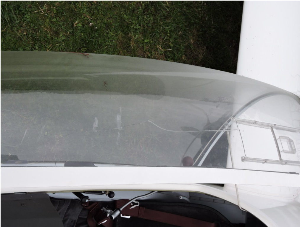
Abb. 6: gebrochene Cockpithaube (Quelle SUB)
