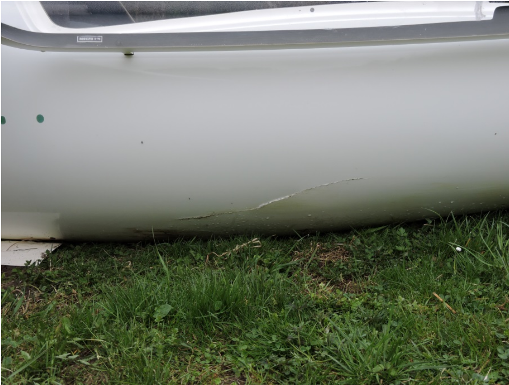
Abb. 3: gebrochene Rumpfschale (Quelle SUB)
