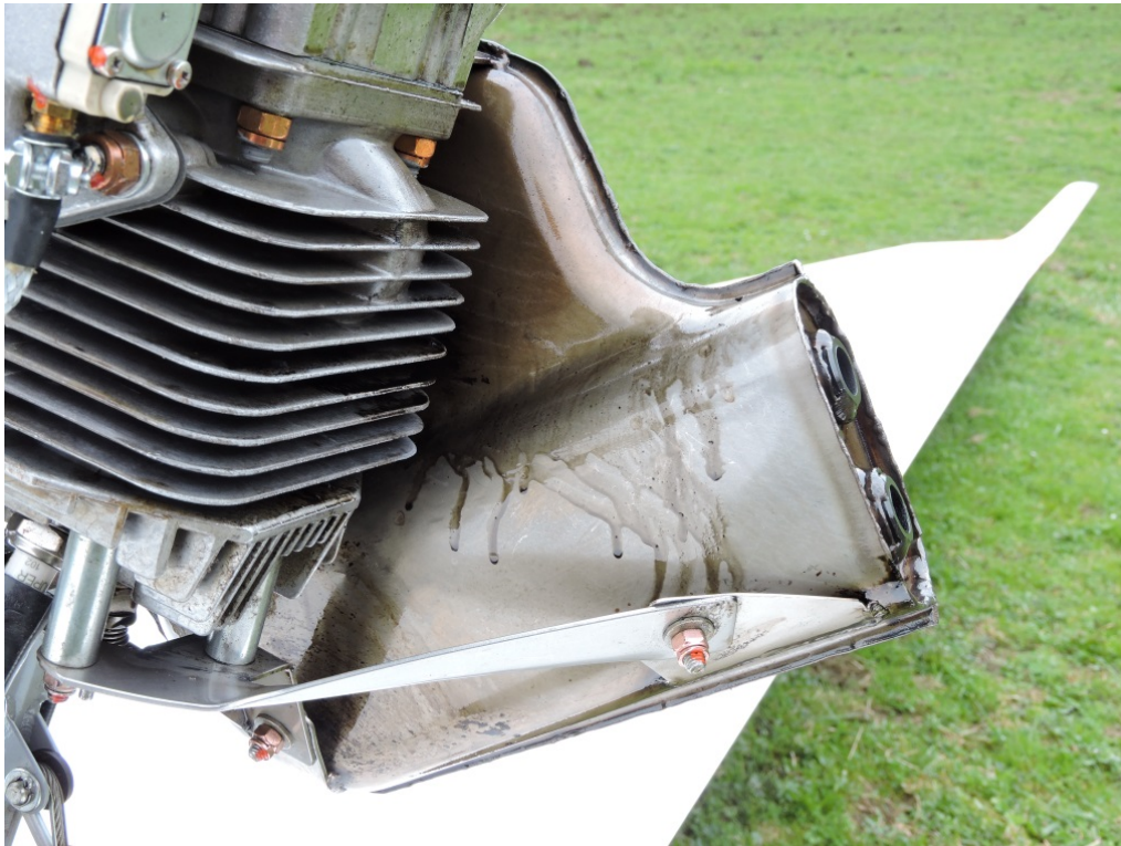
Abb. 8: veröltes Triebwerk (Quelle SUB)
