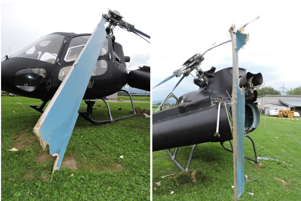
Abbildung 6 (linkes Bild): Beschädigung des Hauptrotorblatts GELB mit Erdauflagerung am Bruchende Abbildung 7 (rechtes Bild): Beschädigung des Hauptrotorblatts ROT mit Erdauflagerung am Blattende
