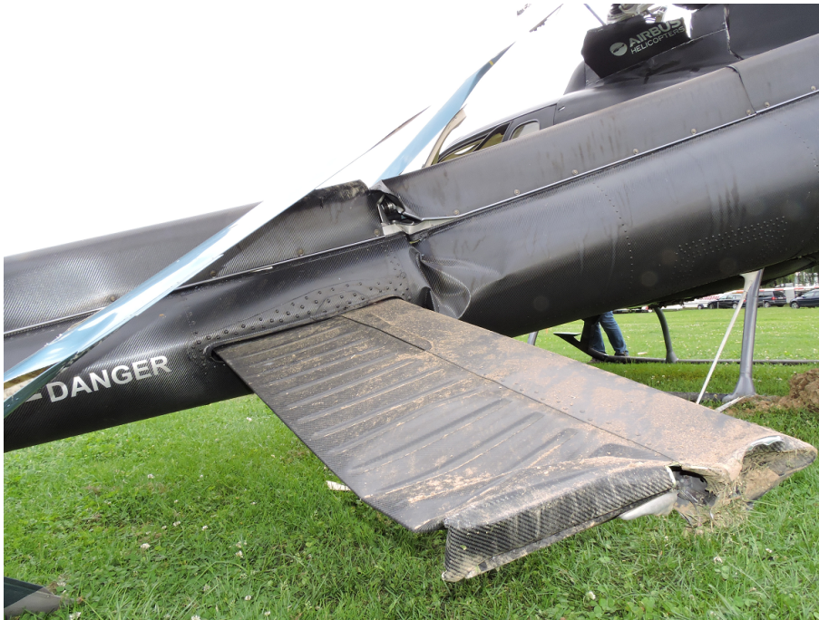
Abbildung 15 Horizontale Stabilisierungsflosse mit Stauchung des rechten Flossenendes und Beschädigung des rechten (steuerbordseitigen) Positionslichts
