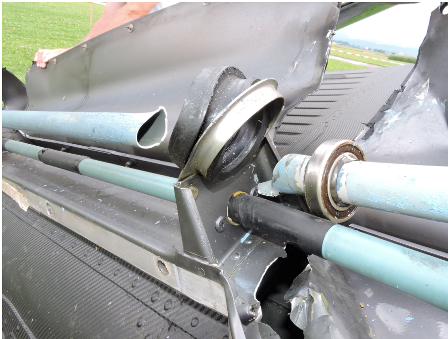
Abbildung 16 In Höhe der Vorderkante der horizontalen Stabilisierungsflossen nach rechts verformter hinterer Teil des Heckauslegers mit gebrochener Heckrotorantriebswelle
