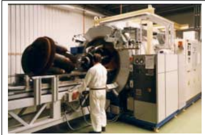
Abb. 3.4: Anlage zur Behandlung von quecksilberhaltigen Abfällen (Quelle: ALD)
