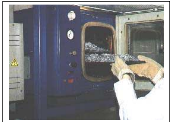
Bild 3.1: Einbringen der LCD-Materialien in den Ofen der Firma VICOR
