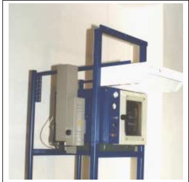
Bild 3.2: Anlage zur Entfernung und katalytischen Umsetzung von LC-Substanzen (Quelle: VICOR, 2001)
