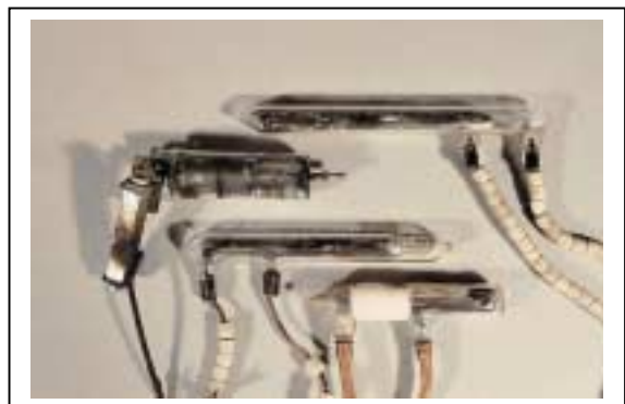
Bild 2.3: Quecksilberschalter aus Boilern
