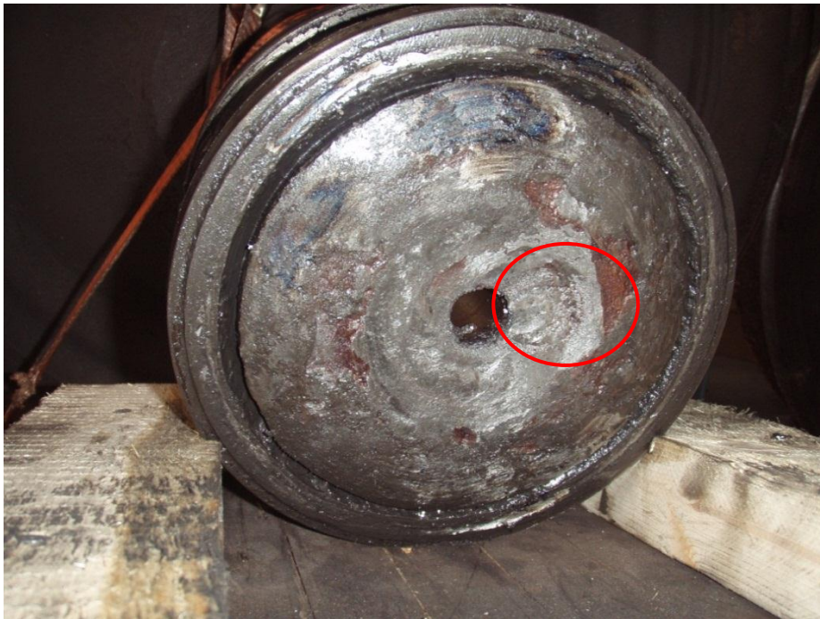
Abbildung 14 Bruchstück des Radsatzes mit Labyrinthring des Achsgetriebes
