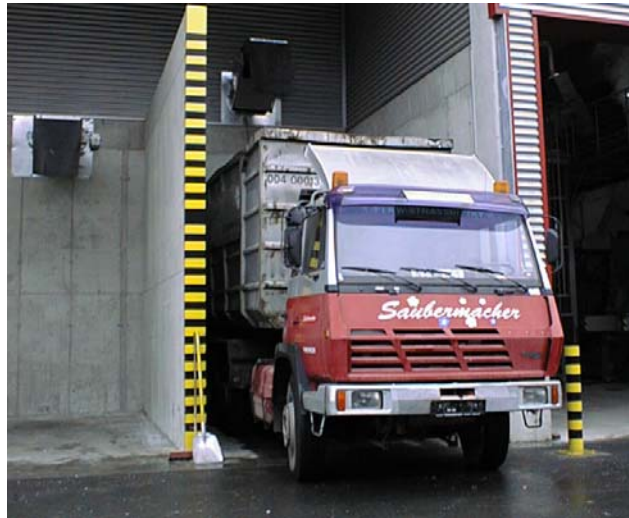
Abbildung 5.4: Im Zuge der Massenbilanzierung wurde die 3D Fraktion direkt am Abwurf der freien Austragstelle aufgefangen
