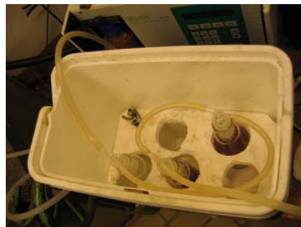
Abbildung 5.7: Absorptionslösung für die Abgase aus dem Schmelzversuch, rechts Zufluss, links Saugpumpe
