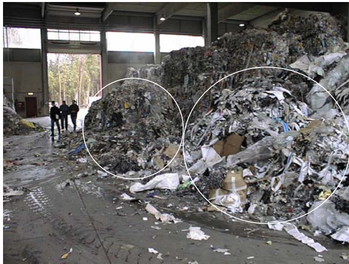
Abbildung 5.2: heizwertreiche Fraktion für die 1. Massenbilanz im Inputlager von ThermoTeam, die Kreise heben die beiden Ladungen des LKW-Zuges hervor.
