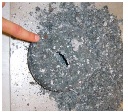
Abbildung 5.9: vorbereitende Schmelzversuche: deutlich zu erkennen sind die Metallkugeln in einer Matrix aus vermutlich Aluminiumoxid
