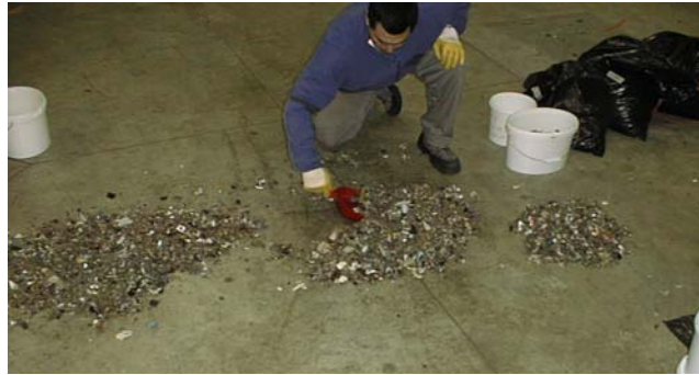
Abbildung 2.2: Verjüngung durch degeneriertes Fraktionales Schaufeln, links das verworfene Material, in der Mitte das zu verjüngende Material, rechts die Teilprobe offen und rechts oben die Teilproben S und SS von vorhergegangenen Mischproben des selben Versuchs in Kübeln
