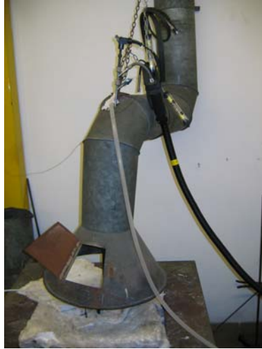
Abbildung 5.8: Versuchsaufbau für das Einschmelzen der Nichteisenmetalle mit einem Induktionsofen unter Spülung mit Ar (durchsichtige Leitung), Temperaturmessung, und Abzug der Gase (schwarze Heizleitung) sowie Abzugshaube mit Sichtfenster. Ofen mit Metalldeckel und Dämmwolle
