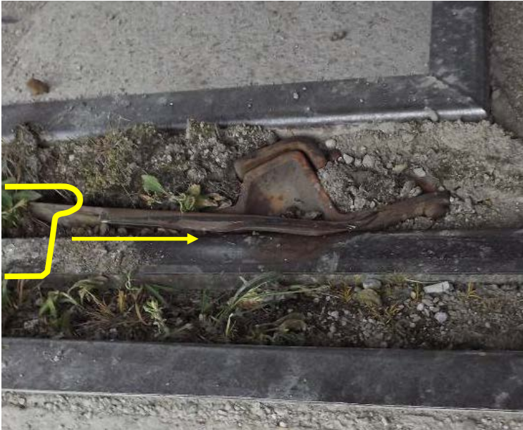
Abbildung 9 Verkeilter Hemmschuh / Detailaufnahme (Quelle PI Marchtrenk)
