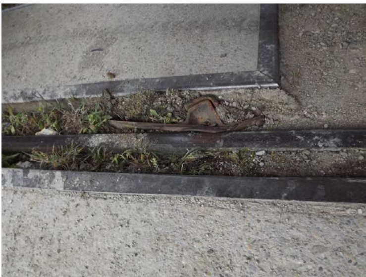
Abbildung 6 Verkeilter Hemmschuh / Detailaufnahme (Quelle PI Marchtrenk)
