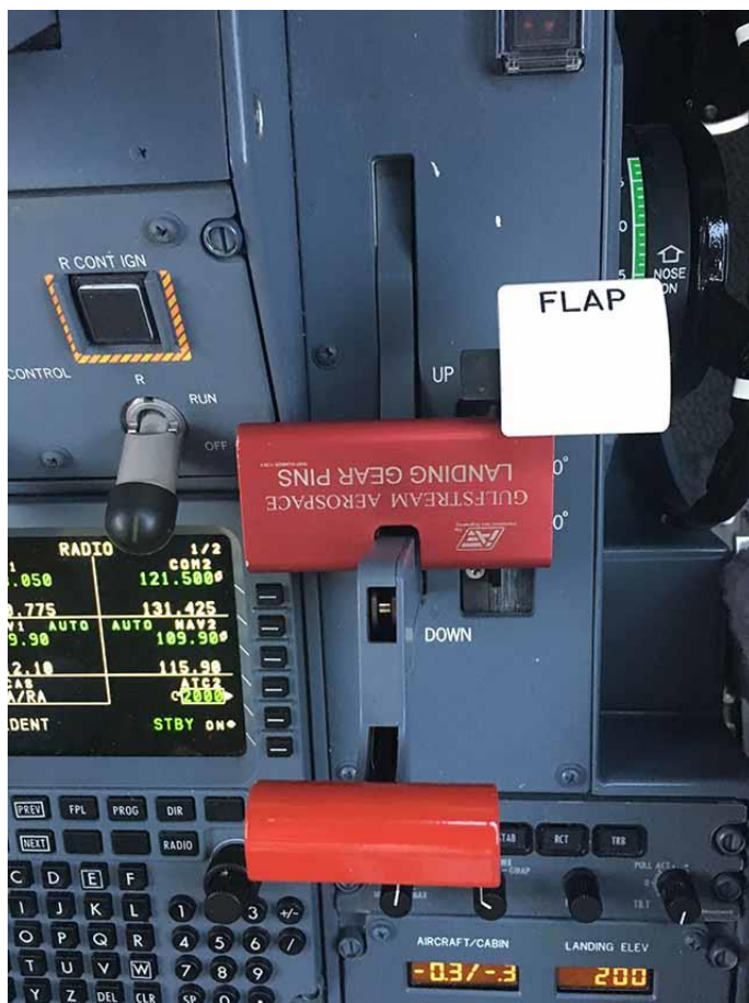
Abbildung 11: Pinholder (roter Block) am Gust Lock Hebel
