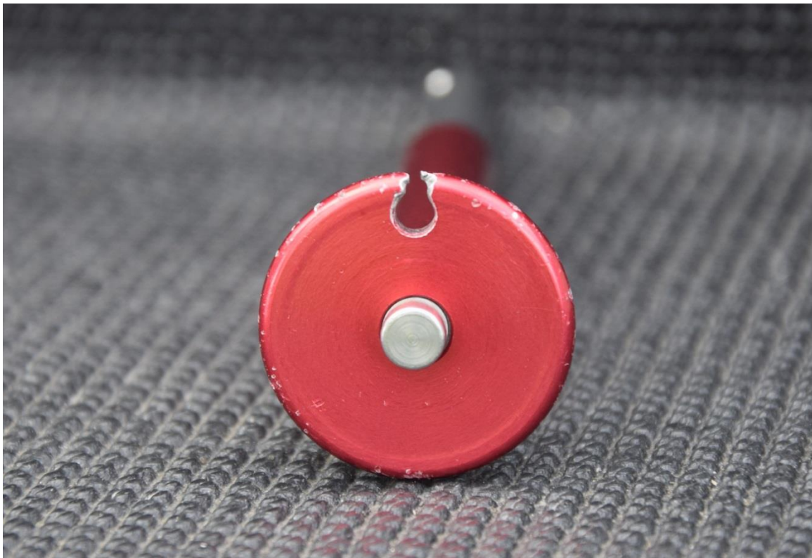
Abbildung 6: Landing Gear Safety Pin des Bugradfahrwerkes
