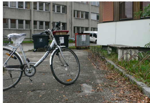
Beispiel für einen Vorderradhalter und Problem der Nichtbenutzung
