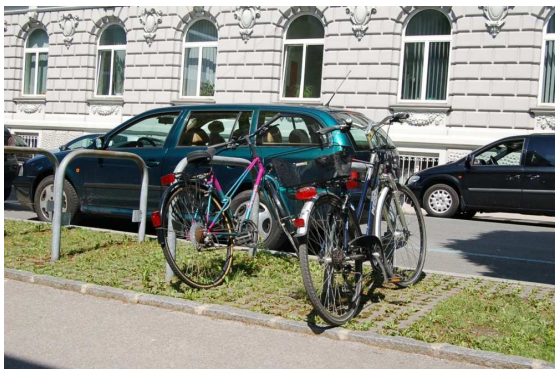
Beispiel für einen Rahmenhalter/Anlehnbügel mit ausreichendem Abstand zu den benachbarten Bügeln
