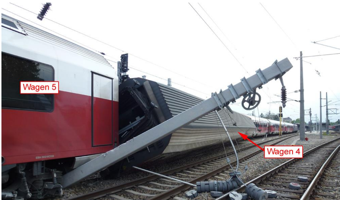
Abbildung 12: Z 631 – Durch den 4. Wagen geknickter Oberleitungsmast
