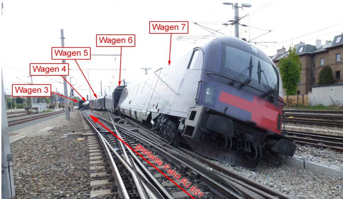
Abbildung 9: Z 631 – Lage der Fahrzeuge nach Kollision – Bild 2
