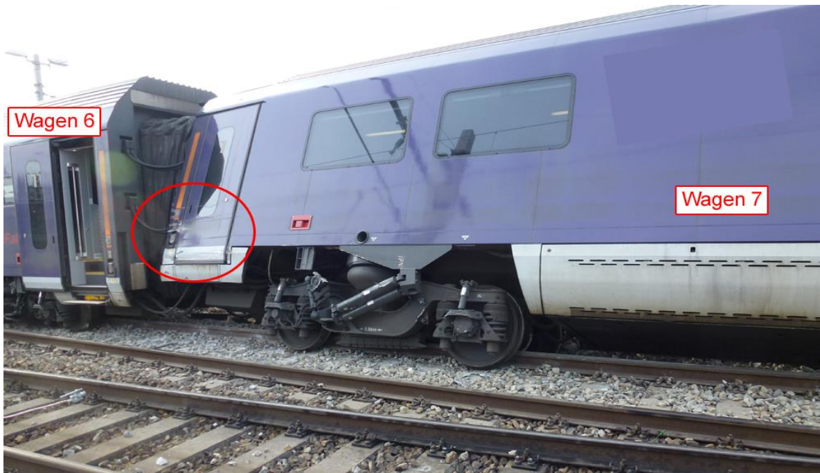
Abbildung 14: Z 631 – Kollisionsspuren am 7. Wagen
