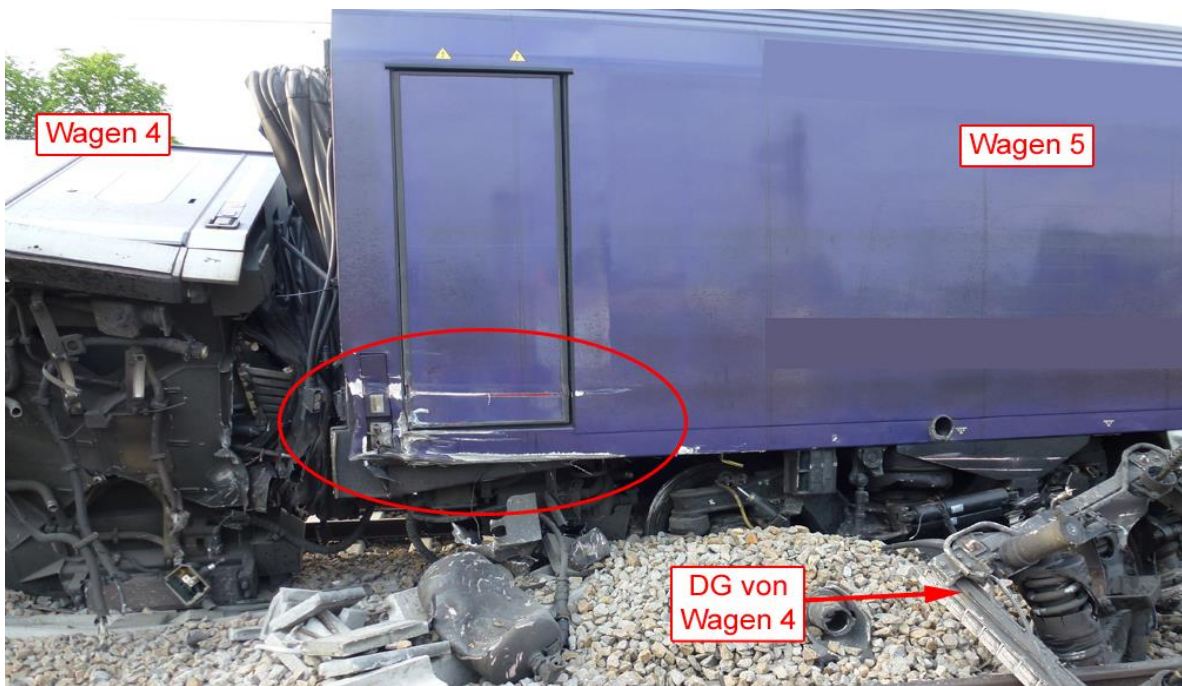
Abbildung 11: Z 631 – Kollisionsspuren am 5. Wagen
