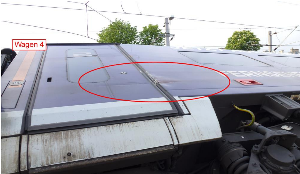
Abbildung 10: Z 631 – erste Kollisionsspuren am 4. Wagen
