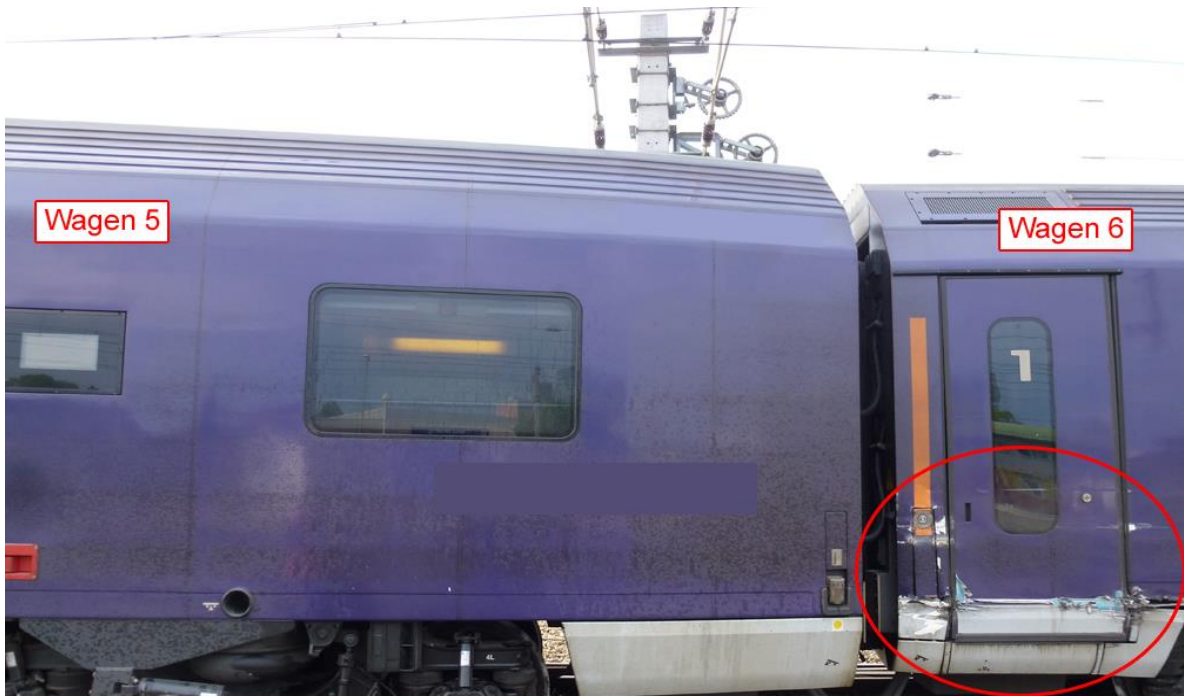
Abbildung 13: Z 631 – Kollisionsspuren am 6. Wagen
