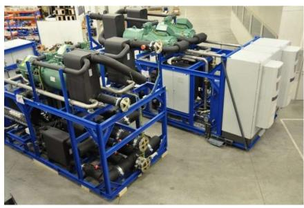
Beispiel Hochtemperaturwärmepumpe Quelle: Frigopol
