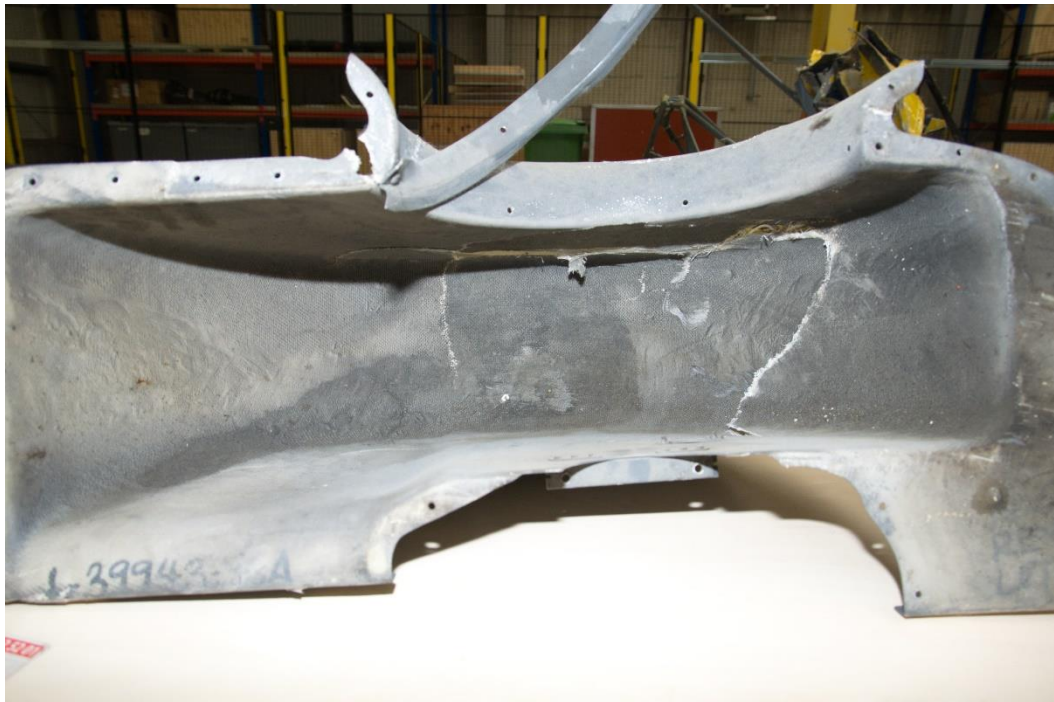
Abbildung 9 Innenseite des unteren Teil des Lüftergehäuses
