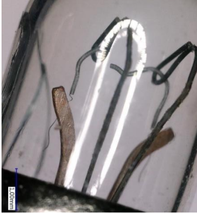
Abbildung 22 Glühfaden der MR CHIP Kontrollleuchte
