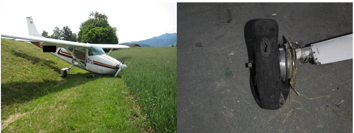
Luftfahrzeugendlage (Quelle: Polizeiinspektion 4663 Laakirchen); linkes Hauptfahrwerksrad
