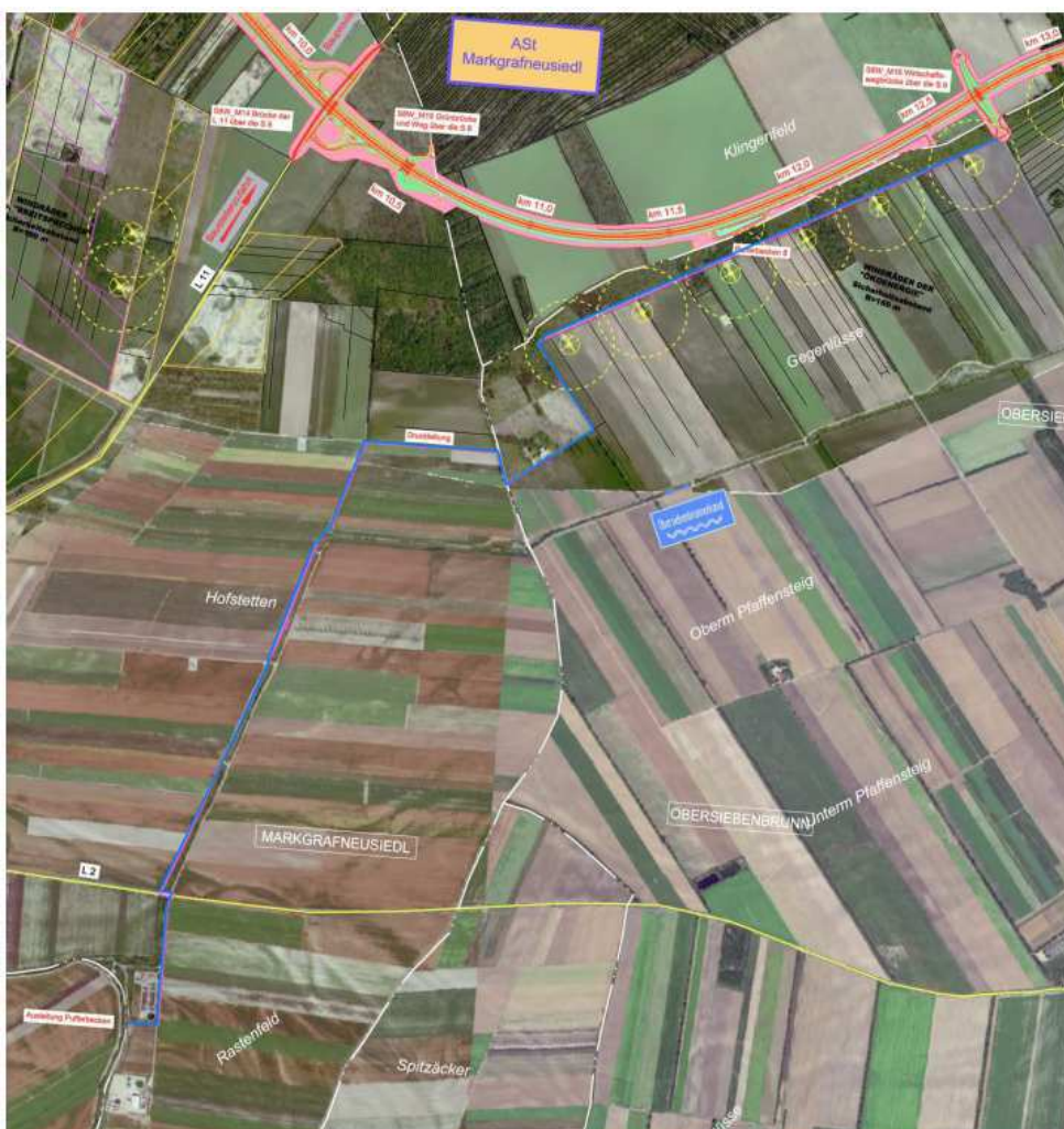
Abbildung 2: Ableitung aus dem Winterwasserreinigungsbecken der S 8 Marchfeld Schnellstraße linksufrig bei Rußbach km 26,79
