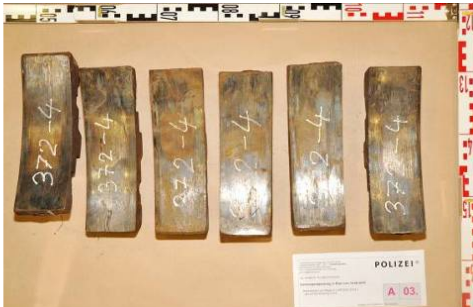
Abbildung 37 Bremssohlen nachlaufender Wagenteil (Quelle LKA-B)
