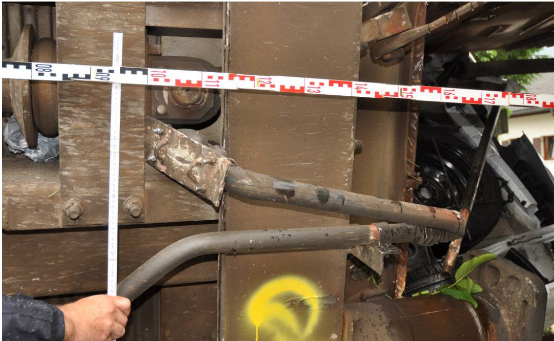
Abbildung 16 geknickter Luftschlauch mit Bremskupplung (Quelle LKA-B)
