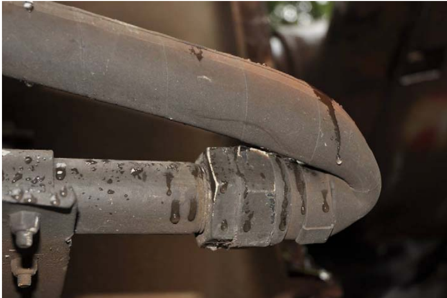
Abbildung 52 geknickter Bremsschlauch Wagen 372-4
