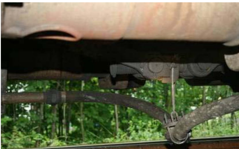
Abbildung 51 Verbindungsstelle HLL Rohr mit Bremsschlauch
