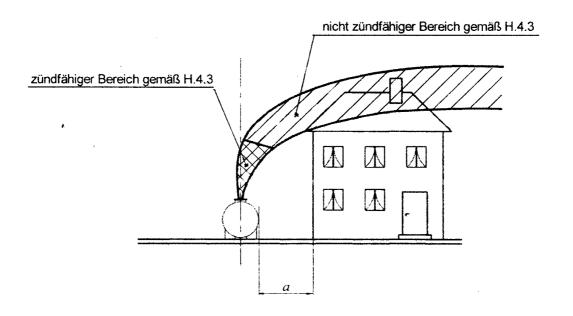
Bild H.4: Zündfähiger Bereich gemäß H.4.3 der Gasaustrittsfahne berührt keine brennbaren Baustoffe/Gebäudeteile
