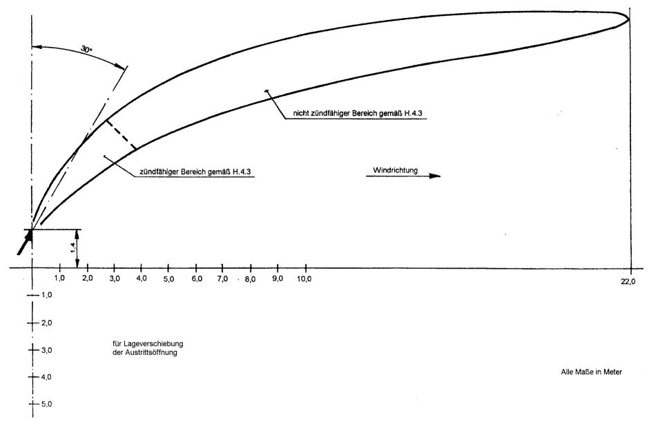
Bild H.8: Gasaustrittsfahne, 30° Ablenkung, in Windrichtung
