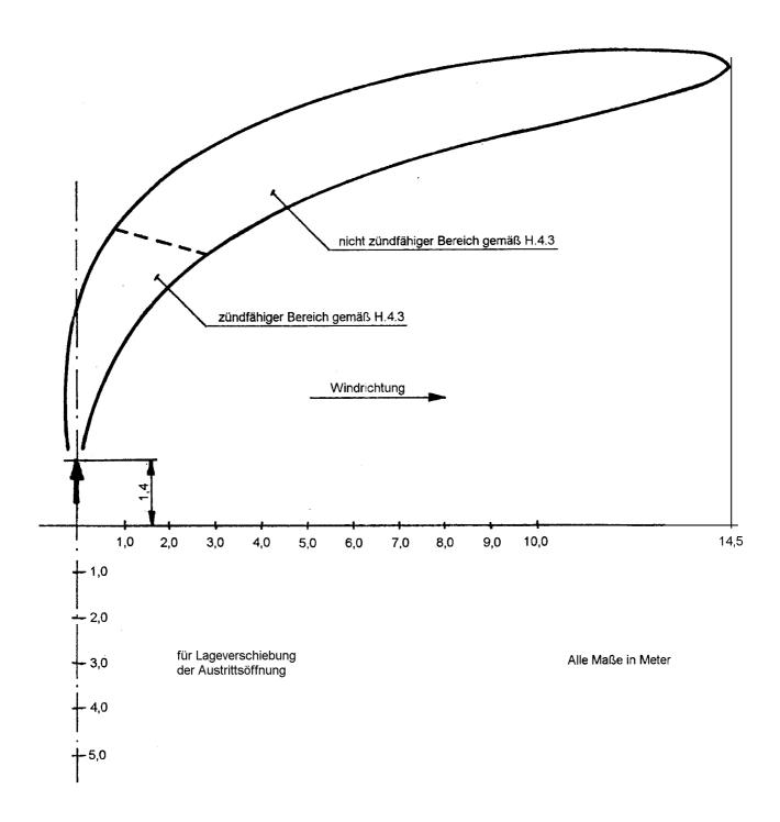
Bild H.6: Gasaustrittsfahne, vertikaler Austritt
