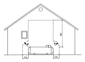
Bild G.1: Anforderungen an die Gebäudewand bei Aufstellung des Druckbehälters parallel zur Gebäudewand
