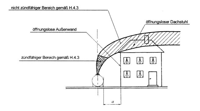
**Bild H.3:** Gasaustrittsfahne (nicht zündfähiger Bereich gemäß H.4.3) berührt öffnungslosen Dachstuhl bzw. öffnungslose Außenmauer
