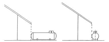
Bild G.3: Aufstellung bei einem Überstand von Dächern oder Balkonen von mehr als 0,5 m
