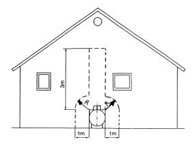
Bild G.2: Anforderungen an die Gebäudewand bei Aufstellung des Druckbehälters stirnseitig zur Gebäudewand
