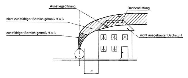
**Bild H.2:** Gasaustrittsfahne (nicht zündfähiger Bereich gemäß H.4.3) berührt den nicht ausgebauten geschlossenen Dachstuhl
