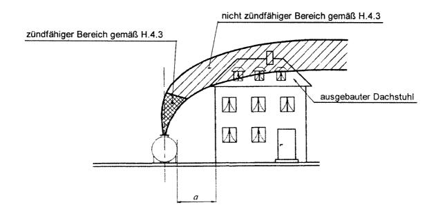
Bild H.5: Dachstuhl zu Wohn- oder Arbeitszwecken ausgebaut
