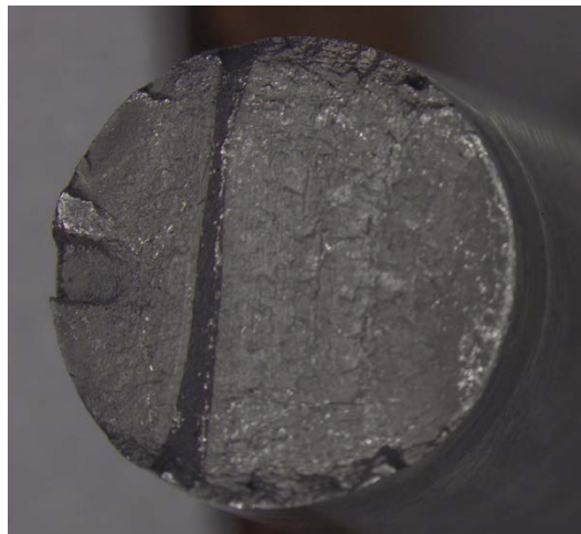
Detailaufnahme der Bolzenbruchstelle Quelle: SUB
