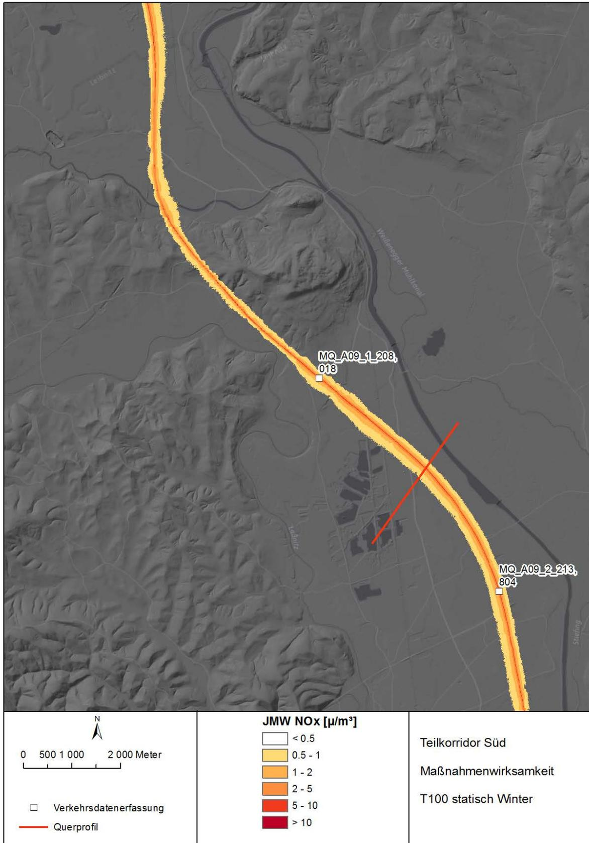
Abbildung 103: Auswirkung des permanenten Tempolimits während des Winterhalbjahres auf den durchschnittlichen NO<sub>x</sub>-Beitrag – Teilkorridor Süd
