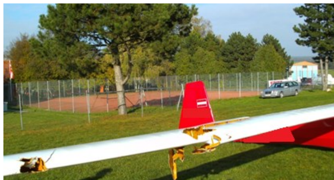
Bild 1 : Beschädigung der rechten Tragfläche
