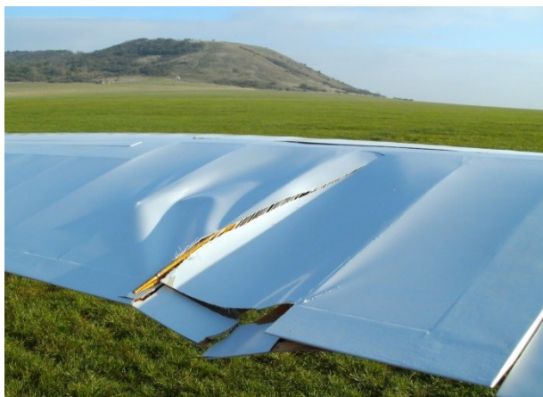
Bild 2 : Beschädigung der rechten Tragfläche Hinterkante
