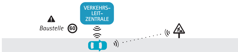
Abbildung 5: Road Works Warning: FahrerInnen werden über bevorstehende Baustellen, ihre relevanten Daten sowie eventuelle Behinderungen informiert (z.B. gesperrte Fahrstreifen).
