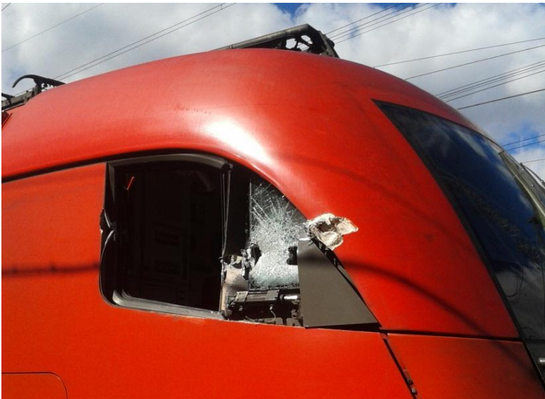
Abbildung 9: Beschädigung des Tfz (Quelle IM)
