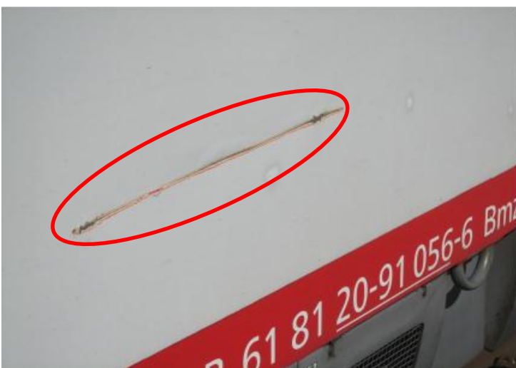
Abbildung 14: Beschädigung 5. Wagen (Quelle IM)
