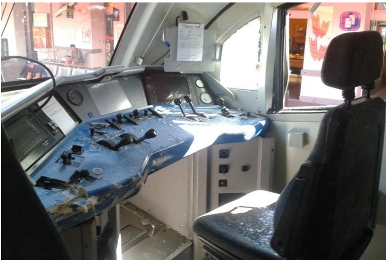
Abbildung 10: Beschädigung Tfz- Führerstand rechts - Position Tfzf (Quelle IM)
