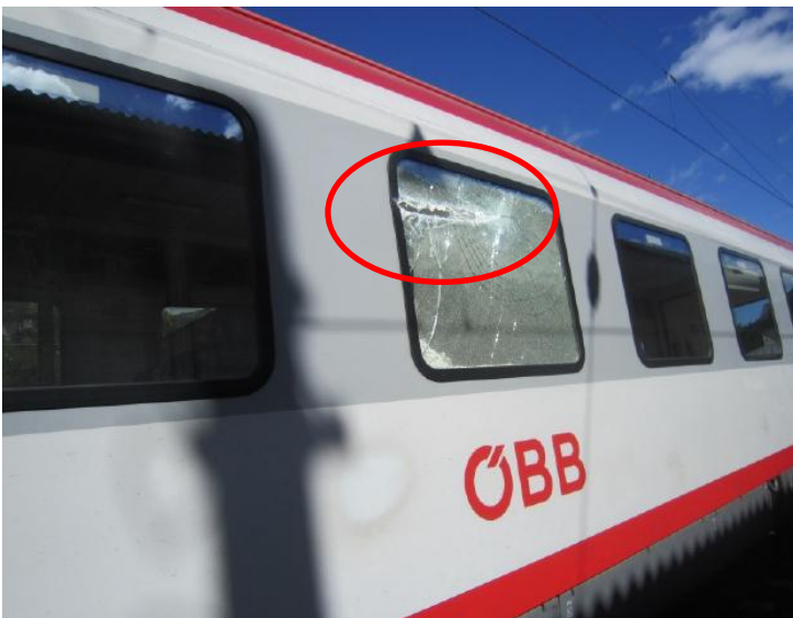
Abbildung 13: Beschädigung 3. Wagen (Quelle IM)
