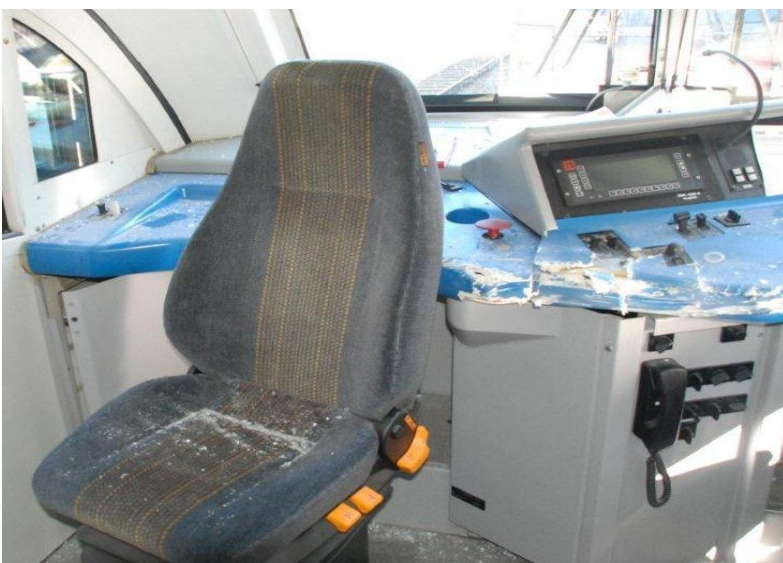
Abbildung 11: Beschädigung Tfz- Führerstand links - Position Tfzf-Instruktor (Quelle PI Telfs)
