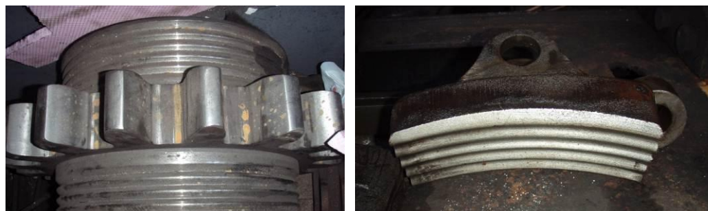
Abbildung 17 Rillenklotz-Handbremse mit Zahnrad und Bremsklotz (jeweils im ausgebauten Zustand)
