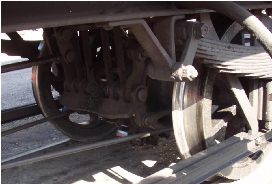
Abbildung 29 Handbremse wirkt auf Bremstrommeln des Zahnrades
