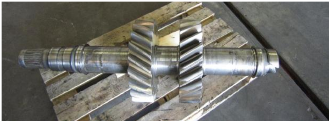
Abbildung 13 Gebrochene Vorgelegewelle – Quelle IM
