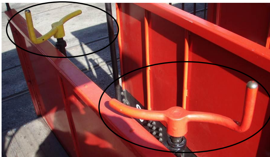
Abbildung 27 Handbremsen am Vorstellwagen 2
