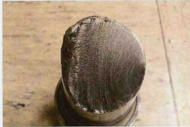
Abb. 2 Bruchfläche der Vorgelegewelle
