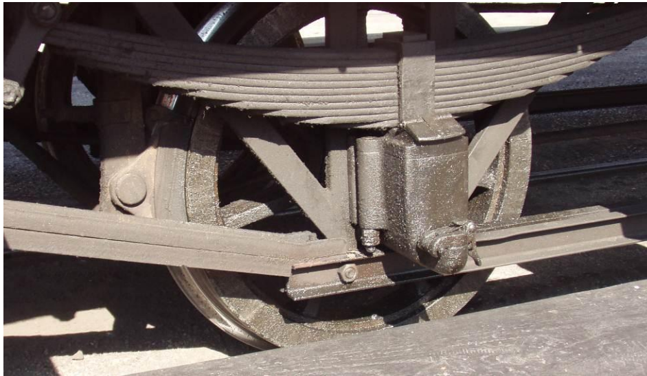
Abbildung 28 Handbremse wirkt auf Adhäsionsräder
