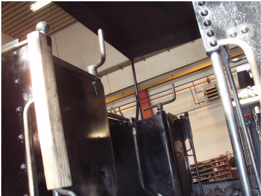
Abbildung 16 Bedienelemente (Kurbeln) der Rillenbandbremse und Rillenklotz-Handbremse auf Zahnrad wirkend
