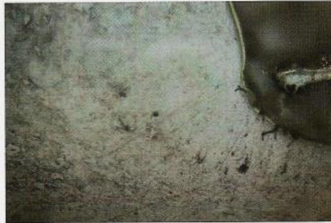
Abb. 5 Mikrorisse im Bruchausgangsbereich
