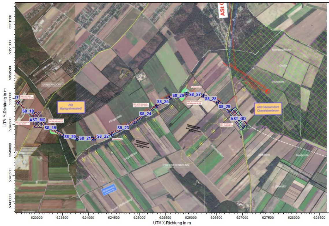
Abbildung 9 Bauphase Trasse/Baufelder: Lage und Bezeichnung der Emissionsquellen (blaue Beschriftung: Volumenquellen, rote Beschriftung: Punktquelle)
