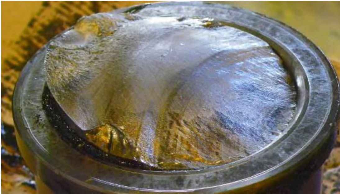
Abbildung 38 Bruchstück (Achsschenkel) A-Seite - Bruchfläche - Quelle RU
