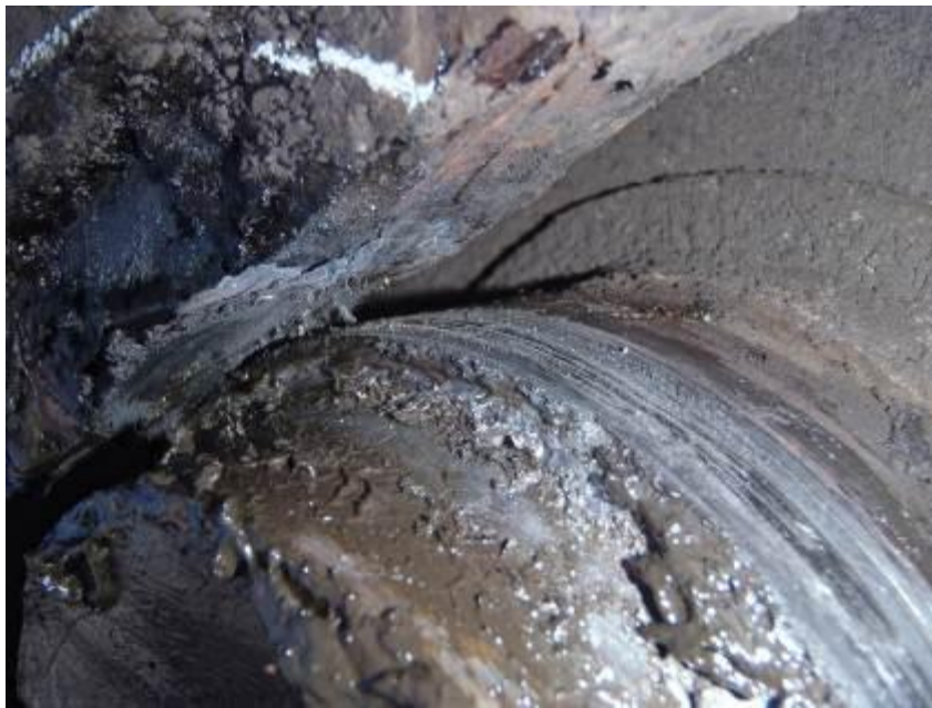
Abbildung 11 Abstützung des Drehgestells am Notschenkel - Quelle IM
