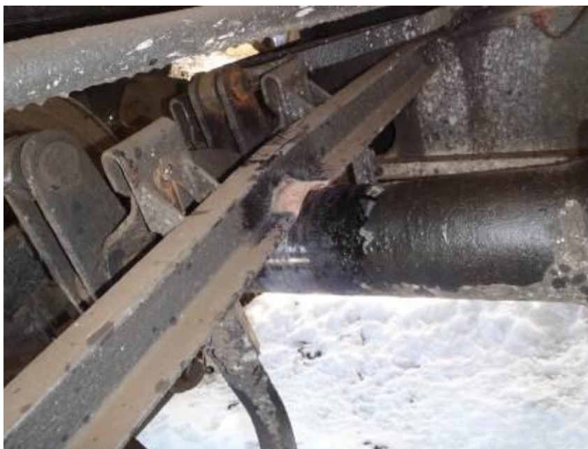
Abbildung 12 Abstützung des Drehgestells auf der Radsatzwelle (1) - Quelle IM
