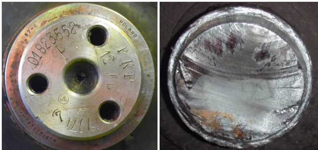
Abbildung 35 Rest der Radsatzwelle – B-Seite – Stirnseite – Bruchfläche Quelle ÖIH
