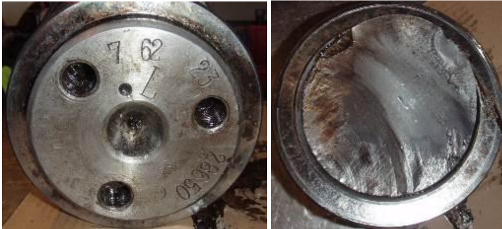
Abbildung 36 Bruchstück (Achsschenkel) A-Seite – Stirnseite - Bruchfläche
