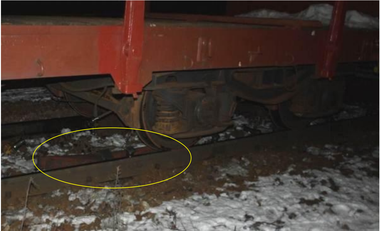
Abbildung 18 Fundstelle Blatttragfeder des entgleisten Kesselwagens - Quelle RU
