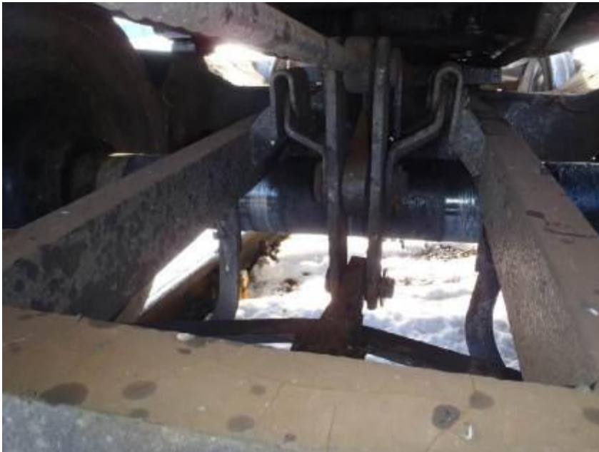
Abbildung 13 Abstützung des Drehgestells auf der Radsatzwelle (2) - Quelle IM
