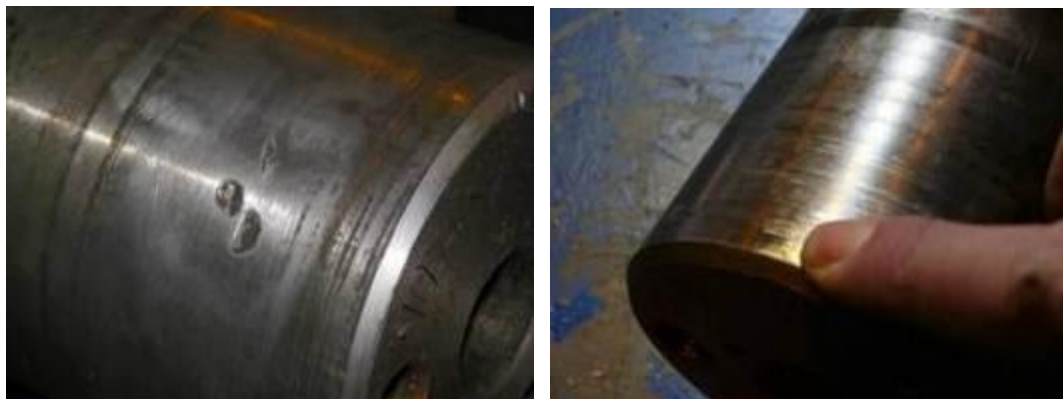
Abbildung 43 Reststück (B-Seite) - Oberflächenschäden - Quelle ÖIH
