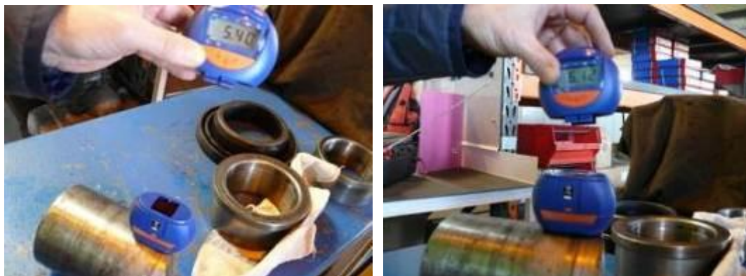
Abbildung 41 Bruchstück (A-Seite) Oberflächenrauigkeit - Quelle ÖIH
