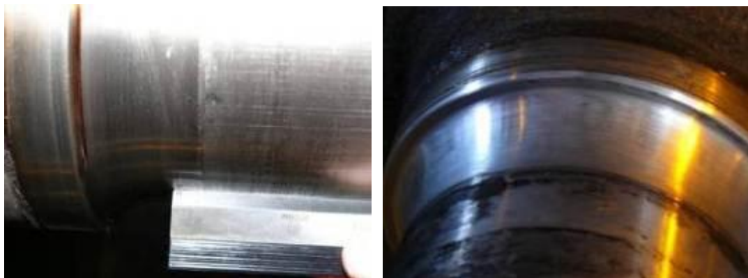
Abbildung 42 Reststück (B-Seite) - Entlastungsmulde und Riefelung - Quelle ÖIH
