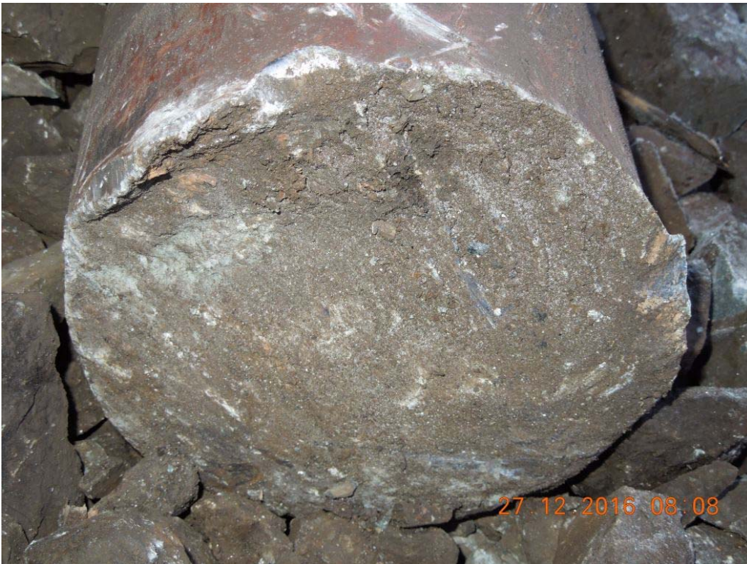
Abbildung 13: Bruchstelle 2 der Radsatzwelle - 31 78 6650 572-8 (Quelle IM)
