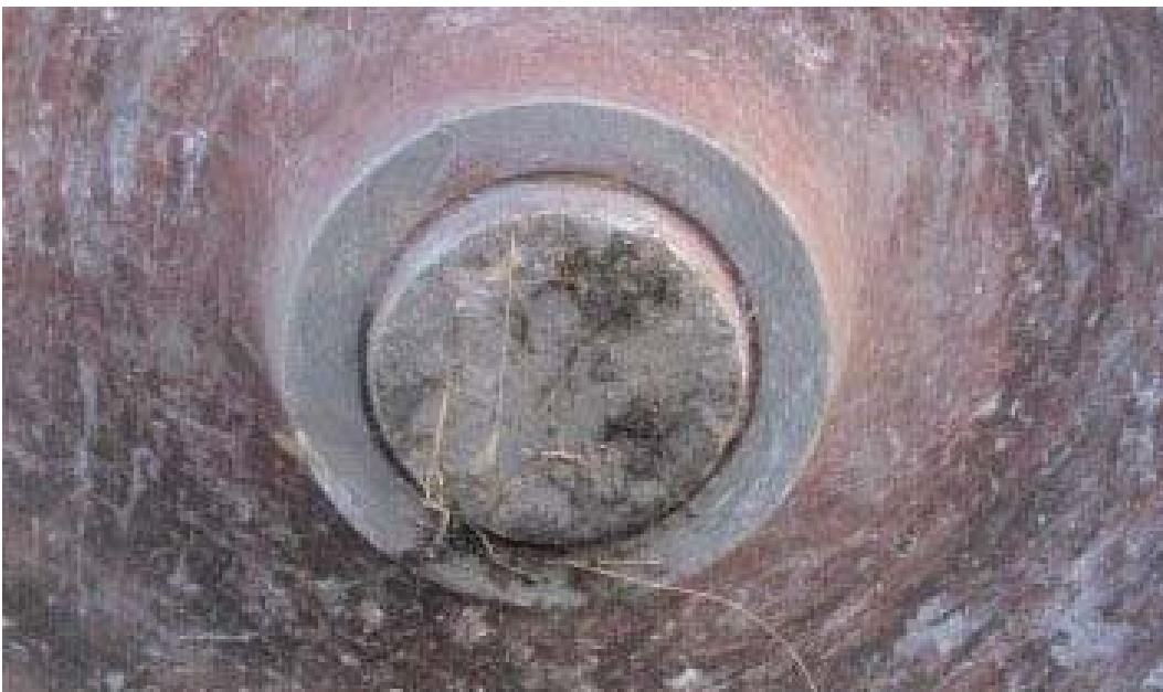
Abbildung 21: Bruchstelle 1 – Nabensitz der Radsatzwelle - 31 78 6650 572-8 (Quelle ÖBB)
