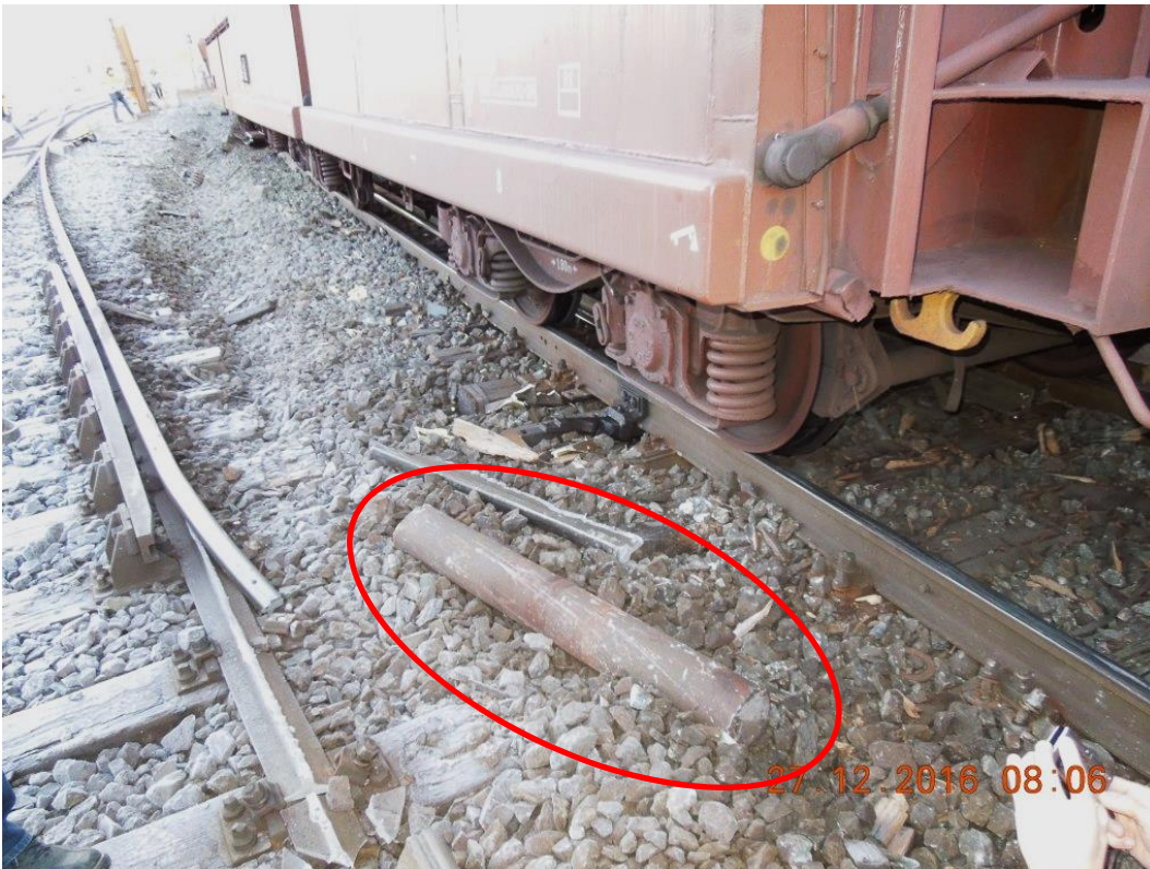
Abbildung 11: Bruchstück der Radsatzwelle (Schaft) - 31 78 6650 572-8 (Quelle IM)
