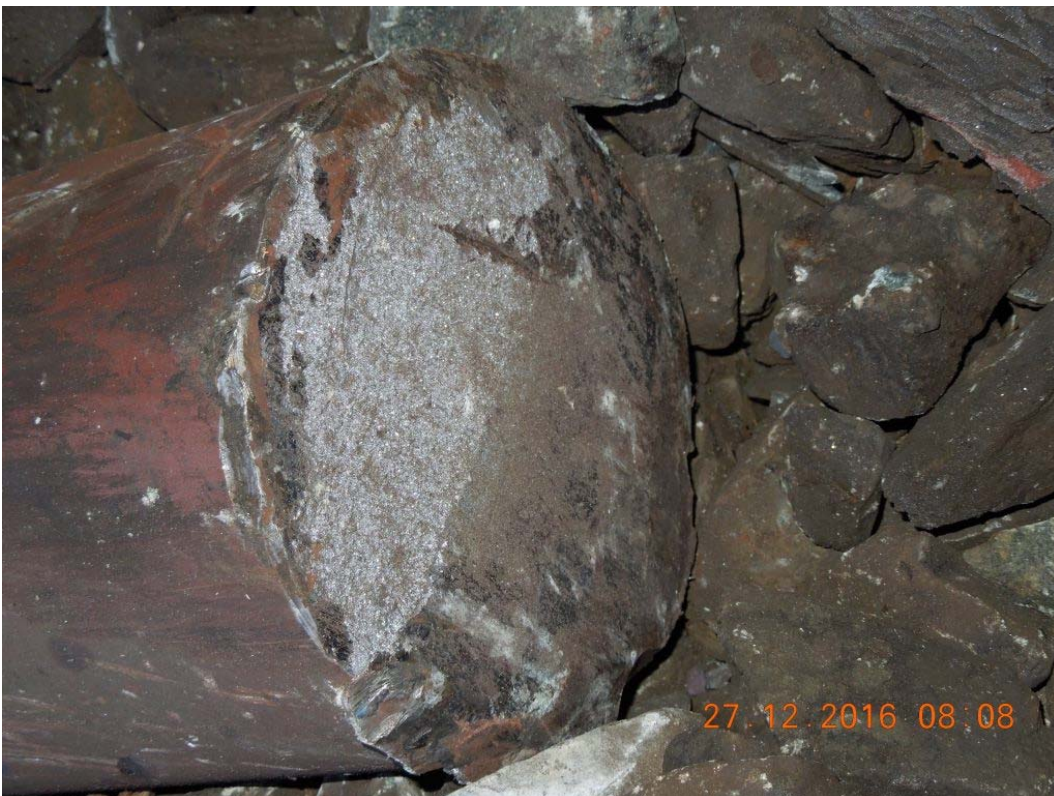
Abbildung 12: Bruchstelle 1 der Radsatzwelle - 31 78 6650 572-8 (Quelle IM)
