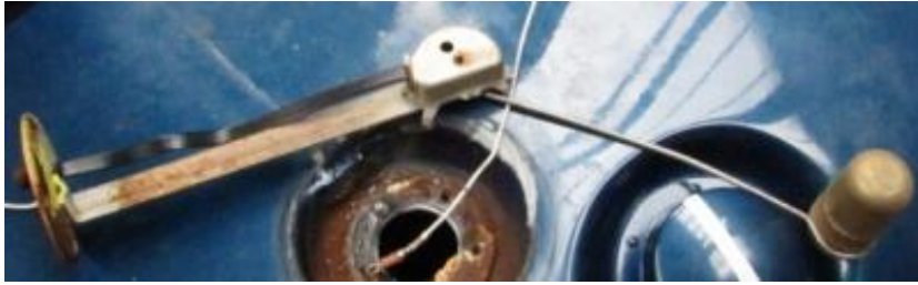
Abbildung 18 Füllstandgeber im ausgebauten Zustand
