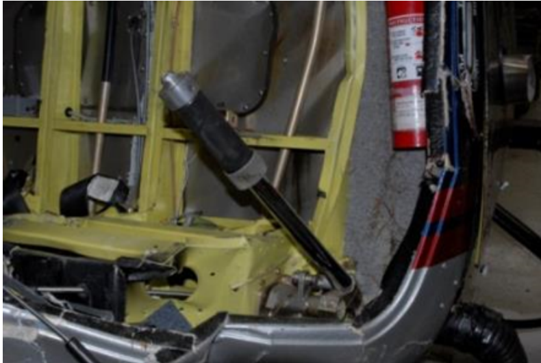
Abbildung 8 Kollektiver Einstellhebel in maximal gezogener Position
