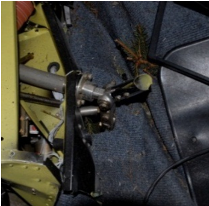
Abbildung 10 Co-Pilot Doppelsteuer zyklischer Stick Bruchstelle
