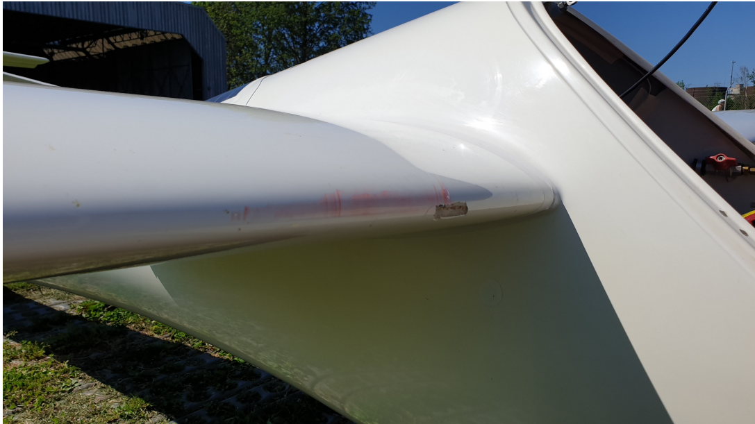
Abbildung 2 Kontaktsuren des Gleitschirmes auf der Profilnase der rechten Tragfläche
