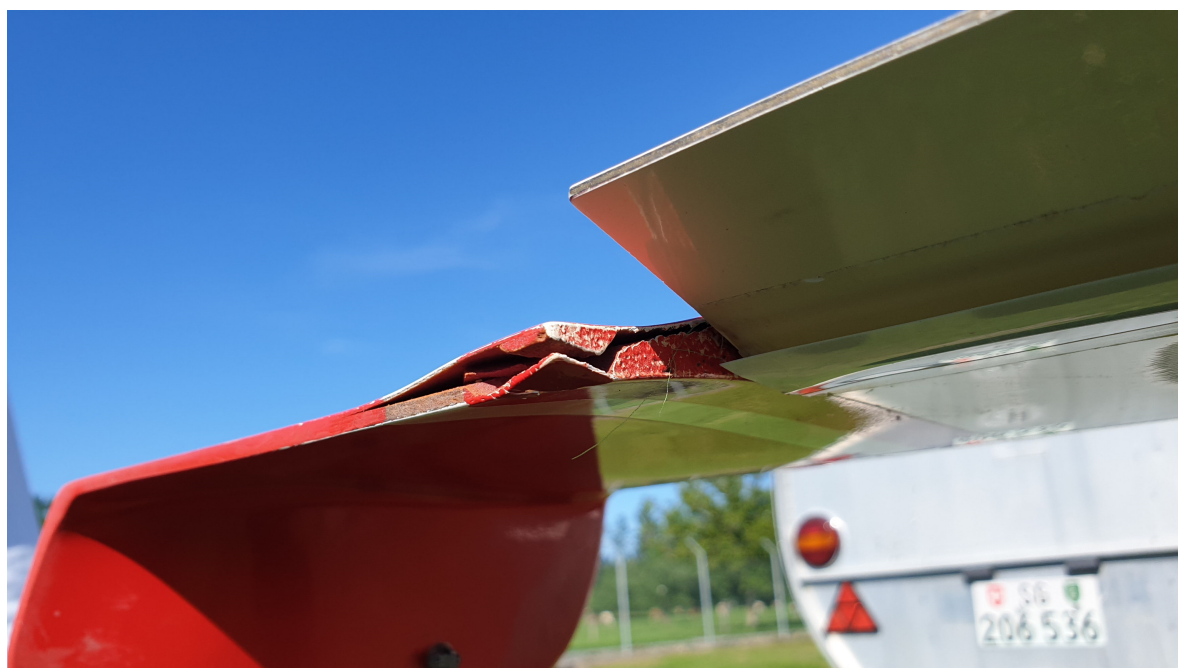
Abbildung 5 Beschädigung der linken Hinterkante des Flügels (beim Spant zum Querruder) durch den Gleitschirm
