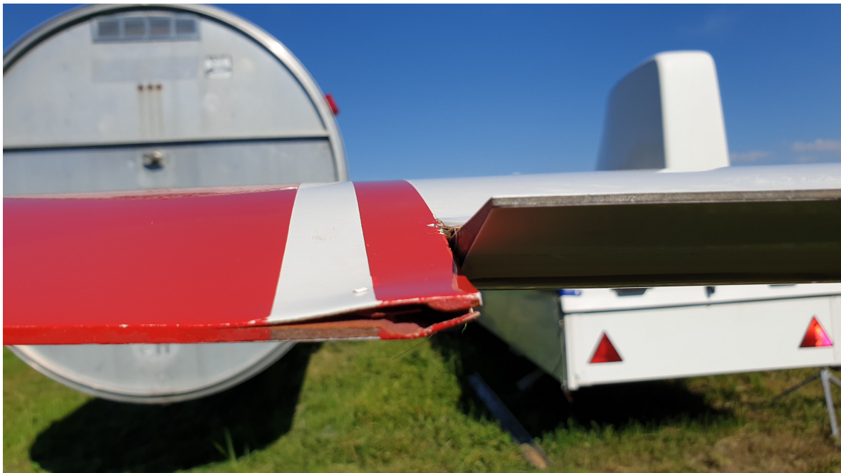
Abbildung 4 Beschädigung der linken Hinterkante des Flügels (beim Spant zum Querruder) durch den Gleitschirm
