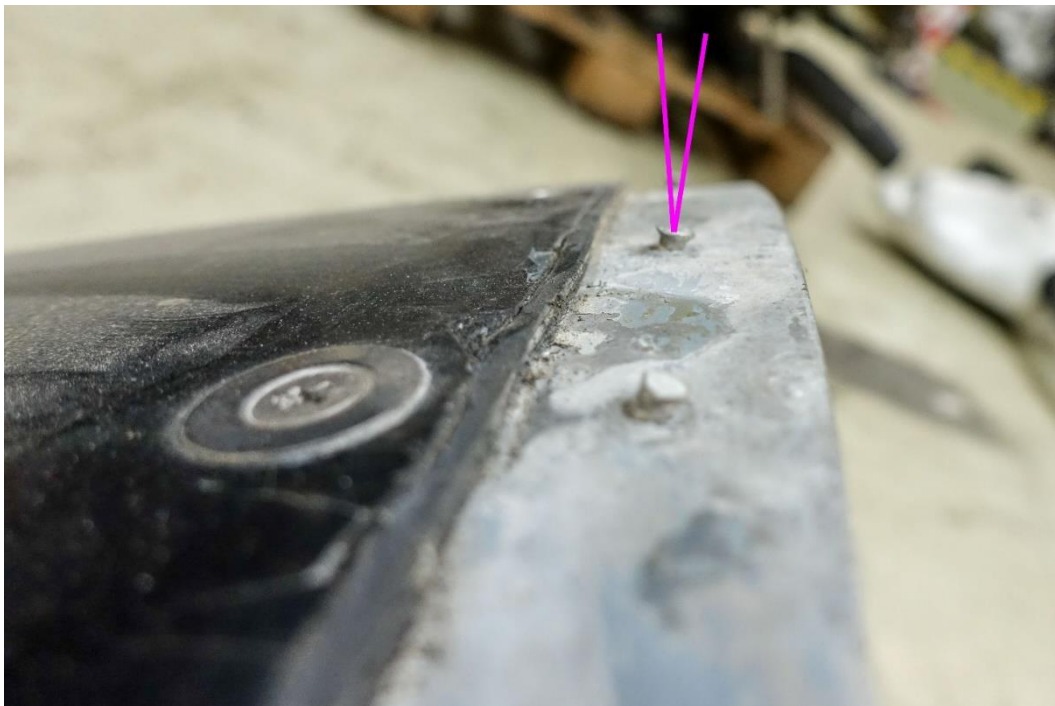
Abbildung 46 (Nietenbild Radom) Nietenwinkel nach Abbruch der Nase nach unten
