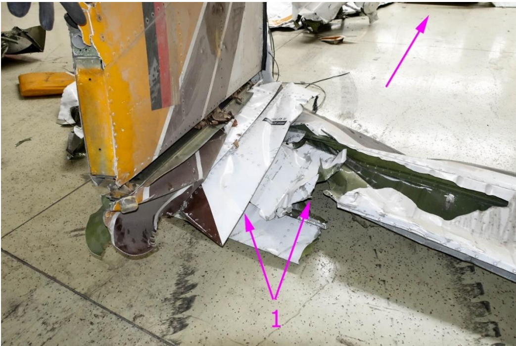
Abbildung 79 Stellprobe Finne mit Seitenruder - rechtes Höhenruder: (1) Kontaktstelle Finne – rechtes Höhenruder
