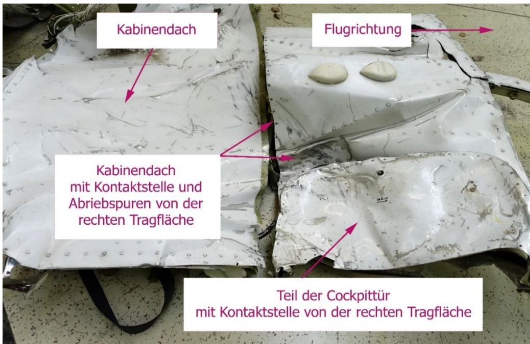
Abbildung 56 Kontaktpuren der Enteisungsanlage
