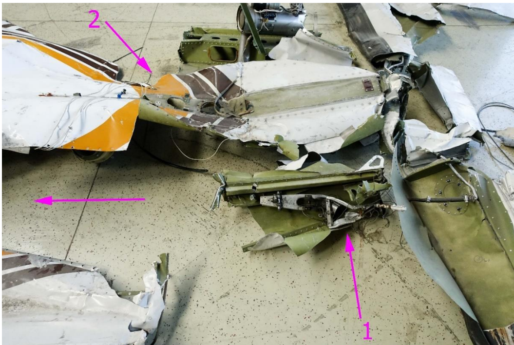
Abbildung 62 (Knickstelle Kabinendach – Finne) (1) Trimmspindel, (2) Abrissknick Kabinendach - Finne
