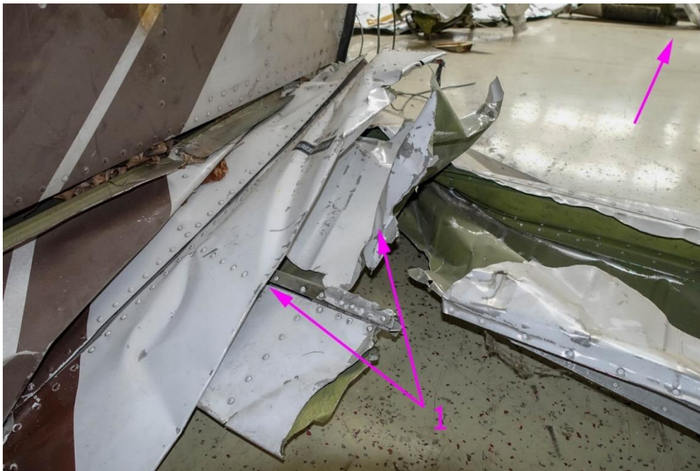
Abbildung 76 Stellprobe Finne mit Seitenruder - rechtes Höhenruder: (1) Kontaktstelle Finne – rechtes Höhenruder
