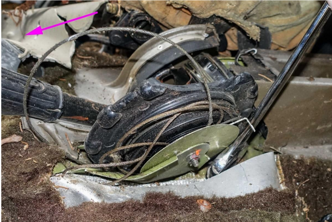
Abbildung 36 Trimmrad mit Trimmindikator
