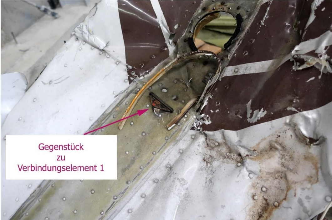
Abbildung 96 Verbindungselement Seitenflosse- Rumpf
