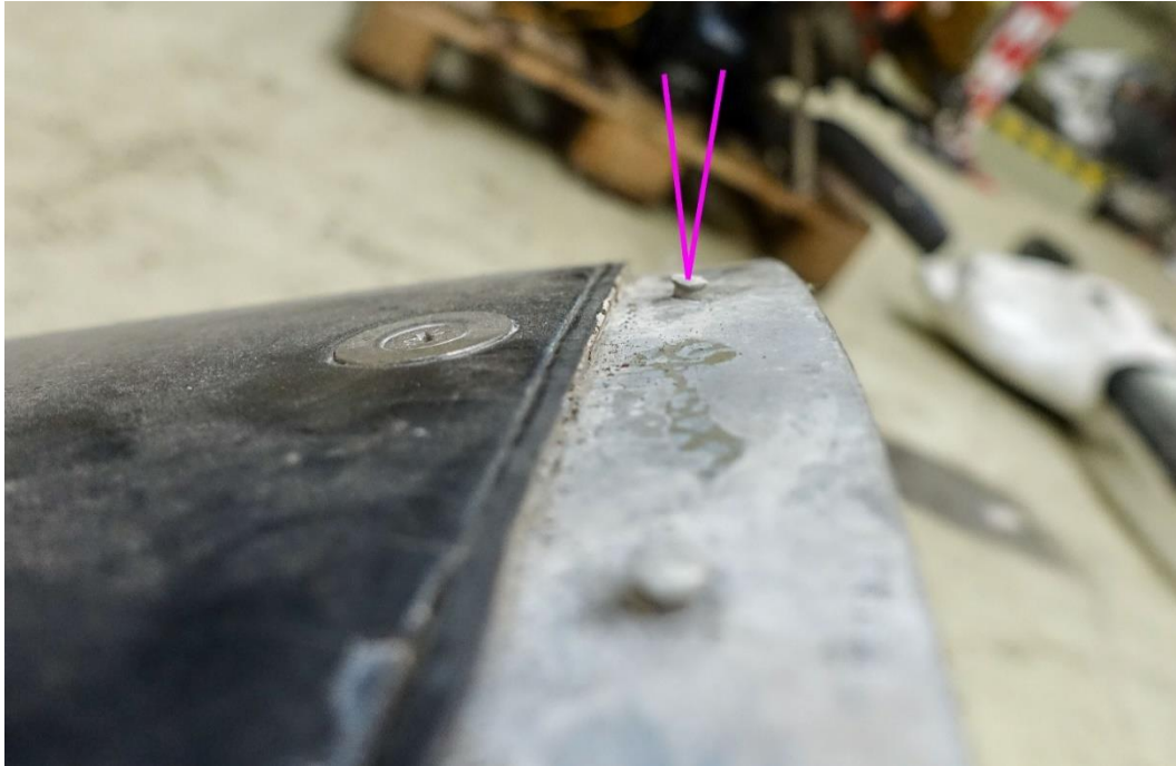
Abbildung 47 (Nietenbild Radom) Nietenwinkel nach Abbruch der Nase nach unten
