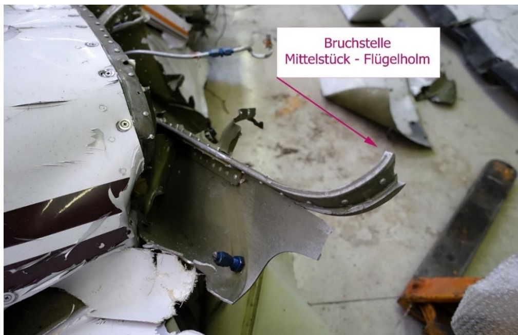
Abbildung 50 (Holmbrüche) Linke Tragfläche
