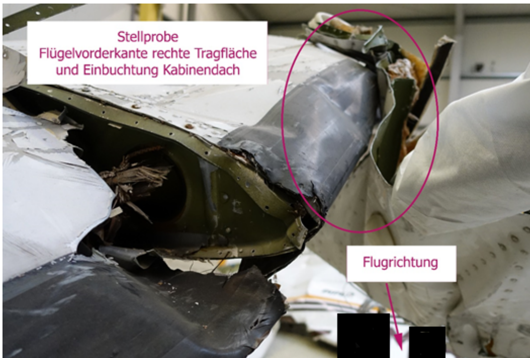
Abbildung 58 Kontaktsuren der Enteisungsanlage
