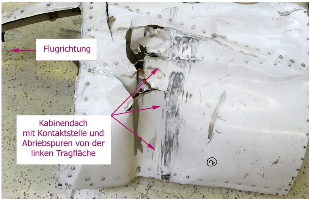
Abbildung 52 Kontaktsuren der Enteisungsanlage
