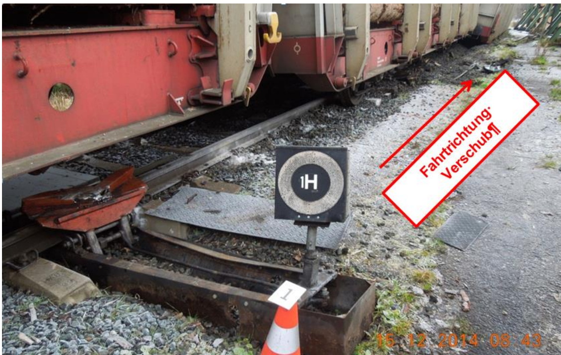
Abbildung 11: Sperrsignal des Sperrschuhs „1H“ und entgleiste Fahrzeugteile (Quelle IM ÖBB)
