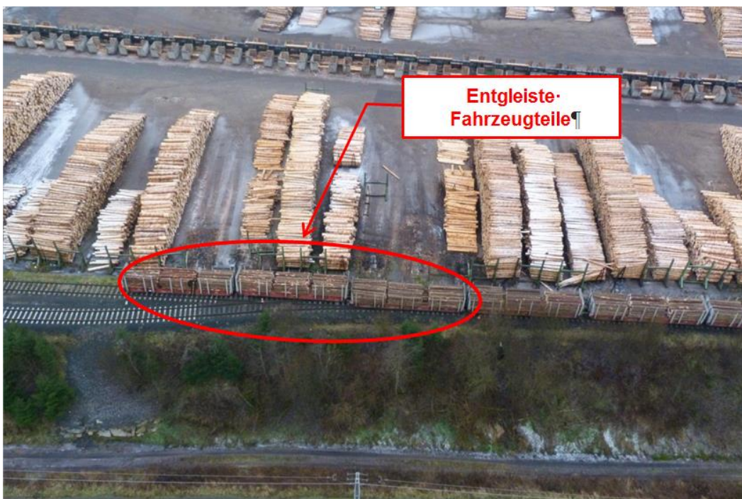
Abbildung 8: Entgleiste Fahrzeugteile (Quelle Polizei)
