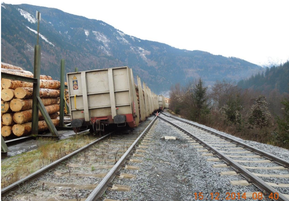
Abbildung 10: Entgleiste Fahrzeugteile (Quelle IM ÖBB)
