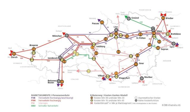
Abbildung 5: Knoten-Kanten-Modell für den Integralen Taktfahrplan im Zielhorizont 2040
