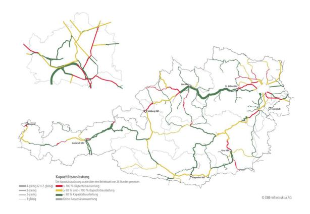
Abbildung 36: Kapazitätsauslastung bei Umsetzung Zielnetz 2040
