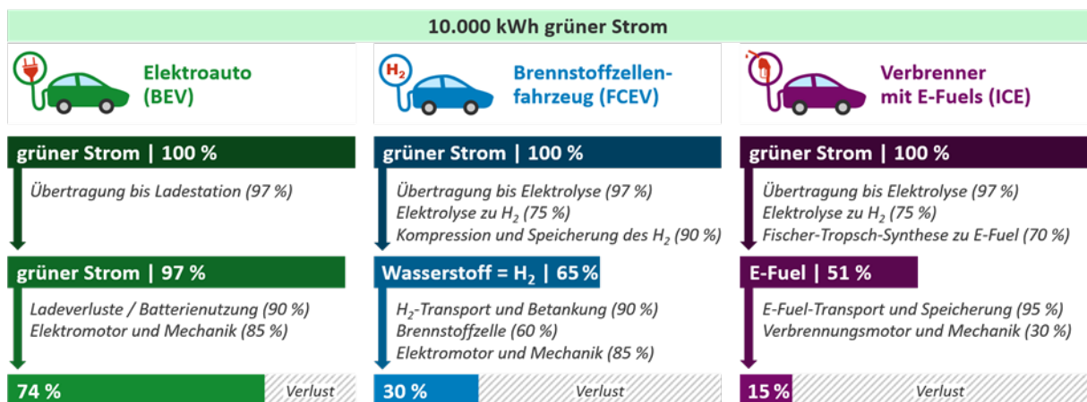
Abbildung 3: Effizienzvergleich von BEV, FCEV, ICE – 100 % Strom-Direktnutzung bei BEV.
