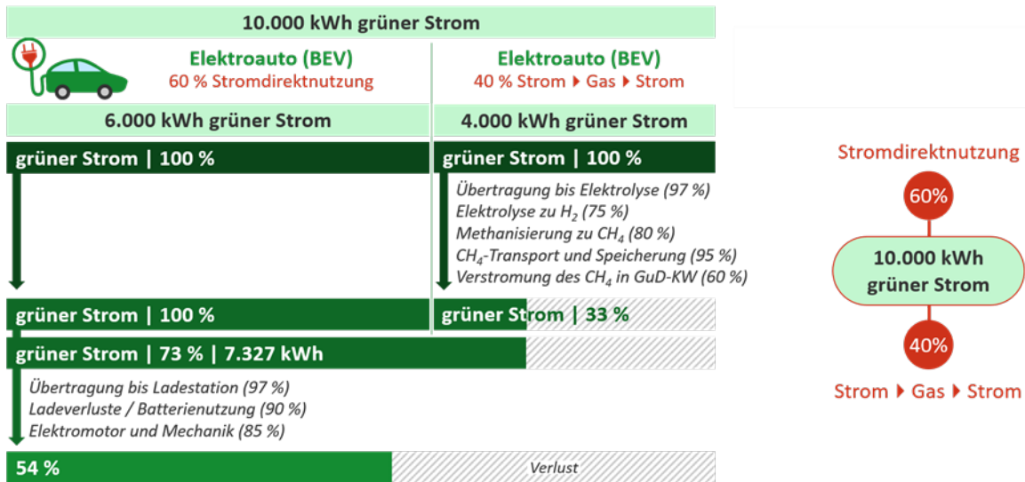
Abbildung 5: Effizienzvergleich von BEV, FCEV, ICE – 60 % Strom-Direktnutzung; 40 % PtG-t-Power bei BEV
