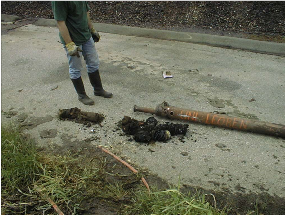
Abbildung 5.4: Gewinnung eines Bohrkernes
