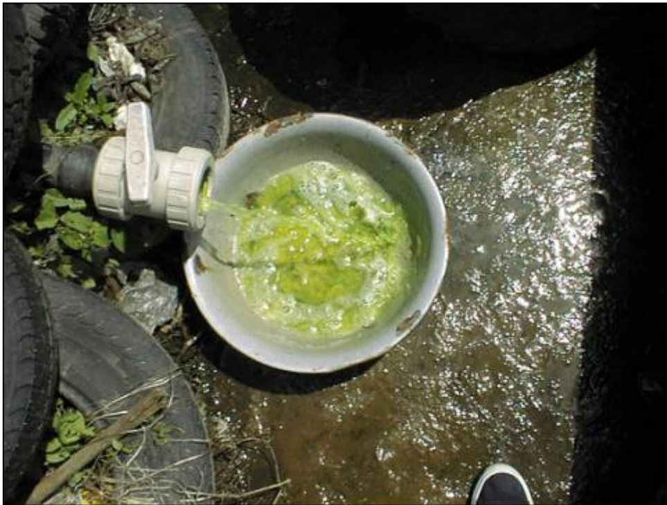
Abbildung 4.13: Sickerwasseraustritt, 1 Tag nach Bewässerung
