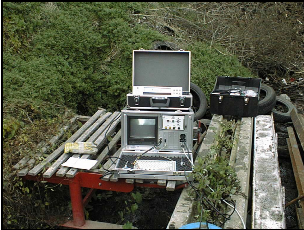
Abbildung 4.18: Monitor der Kanalkamera
