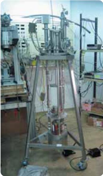
In einem Versuchsaufbau wird der Wärmeübergang über Kugeln zwischen ebenen Platten bei einer Temperaturdifferenz von Raumtemperatur zu Flüssigwasserstofftemperatur kalorimetrisch gemessen. Das Messprinzip folgt der Temperaturdifferenzmessung über eine kalibrierte Temperaturabbaustrecke auf der Kaltseite des Messaufbaus.
