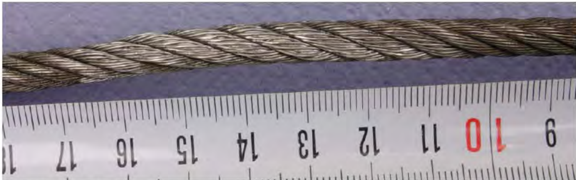
Bild 27: (DSCN5546.JPG) Seilstück 3.1, Zone IV (Berührungsbereich Seil / Seil). Die Seilklemme 1 befand sich zu Versuchsbeginn bei etwa 16cm und wurde nach rechts abgezogen. Die Litzen sind verquetscht und die Außendrähte auseinandergedrückt.
