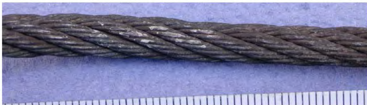
Bild 11: (DSCN5576.JPG) Seilbereich um Position 7 (Bild 6). Am Seil befindet sich angelagertes Fremdmaterial. Im rechten Teil des Bildes sind Verschleißflächen sichtbar, die eindeutig von einer früheren Verwendung bzw. der anderen Einbaulage des Seiles stammen. Die abgenutzten Drahtoberflächen sind zwischenzeitlich wieder verunreinigt und korrodiert.
