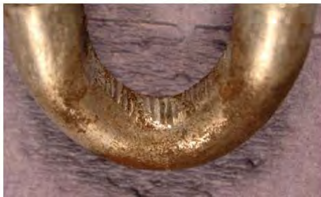
Bild 24: (DSCN5516.JPG) Seilklemme 1, Abdruck der Seiloberfläche im Klemmbereich des Bügels.
