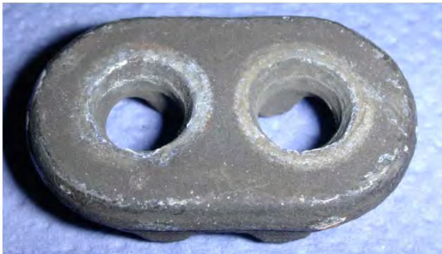
Bild 14: (DSCN5407.JPG) Probe 1, Seilklemme, Rückseite von der Klemmplatte. Druckspuren der Muttern sind zum Teil sichtbar.
