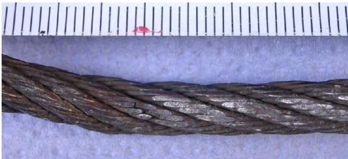
Bild 9: (DSCN5574.JPG) Verschleißstelle auf der Krümmunginnenseite von Position 6 in Bild 6. Drei bis vier Drähte einer Litze sind vollständig durchgeschuert. Daneben liegende Drähte bzw. Litzen weisen den für dieses Seilstück typischen Verschleiß auf.
