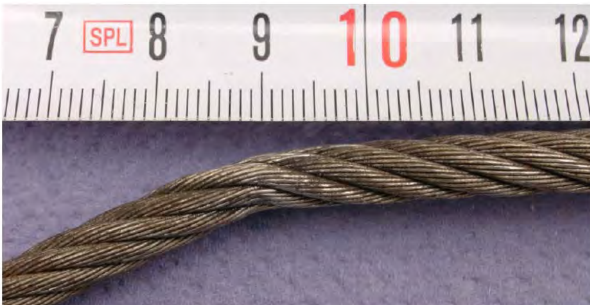
Bild 32: (DSCN5532.JPG) Seilstück 3.2, Zone VIII (Berührungsbereich Klemmbügel / Seil). Die Seilklemme 1 befand sich bei etwa 9cm. Der Abdruck des Klemmbügels führte zu einer Knickstelle im Seil.
