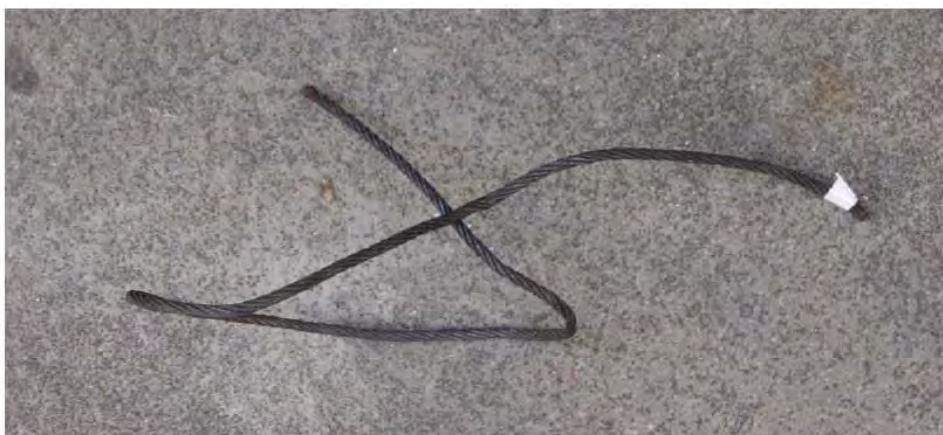
Bild 2: (DSCN5564.JPG) An die TVFA – TU WIEN angeliefertes und als Schadensseil bezeichnetes Seilstück. Das Seil ist gemäß äußerer Form mit jenem von Bild 1 identisch. Die Biegungen stimmen überein. Die Drehlage des Seiles in dieser Aufnahme ist gegenüber der in Bild 1 etwas verändert.
