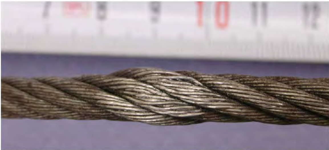
Bild 31: (DSCN5535.JPG) Seilstück 3.2, Zone VII (Berührungsbereich Seil / Seil). Die Seilklemme 1 befand sich bei etwa 9cm. Die Litzen sind örtlich stark verquetscht und die Außendrähte auseinandergedrückt.
