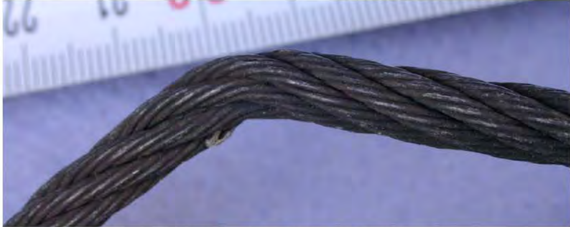
Bild 7: (DSCN5566.JPG) Knickstelle des Seiles (Bild 6, Position 2)
