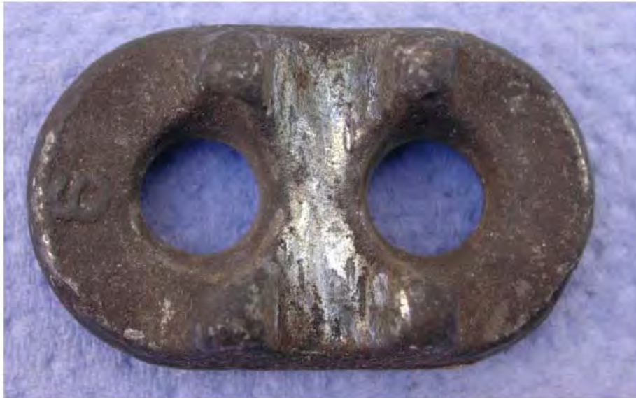
Bild 13: (DSCN5584.JPG) Probe 1, Seilklemme, Klemmplatte der Seilklemme mit Blick in den Seilkanal. Die Kennzeichnung Größe 6 ist links sichtbar.
