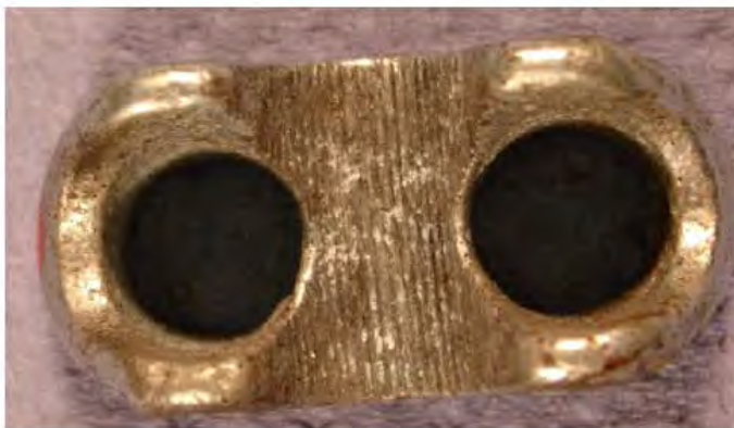
Bild 22: (DSCN5513.JPG) Seilklemme 1 von Probe 3, aufgenommen in zerlegtem Zustand nach dem Zugversuch.
