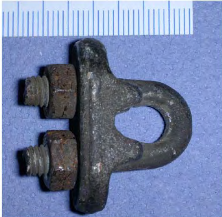
Bild 3: (DSCN5398.JPG) Seilklemme vom Schadensseil.
