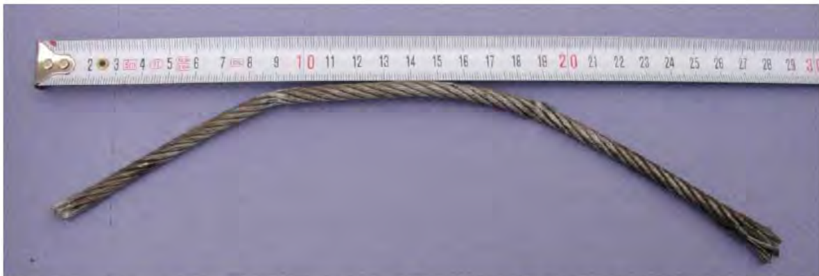
Bild 28: (DSCN5529.JPG) Seilstück 3.2, Überblick. Am linken Ende war die Klemme zur Kräfteinleitung durch die Zugprüfmaschine befestigt. Bei etwa 9cm befand sich die Seilklemme 1 mit den Verschleißzonen VII (Seil / Seil) und VIII (Bügel / Seil). Bei etwa 19cm befand sich die Seilklemme 2 mit den Verschleißzonen V (Seil / Seil) und VI (Bügel / Seil).
