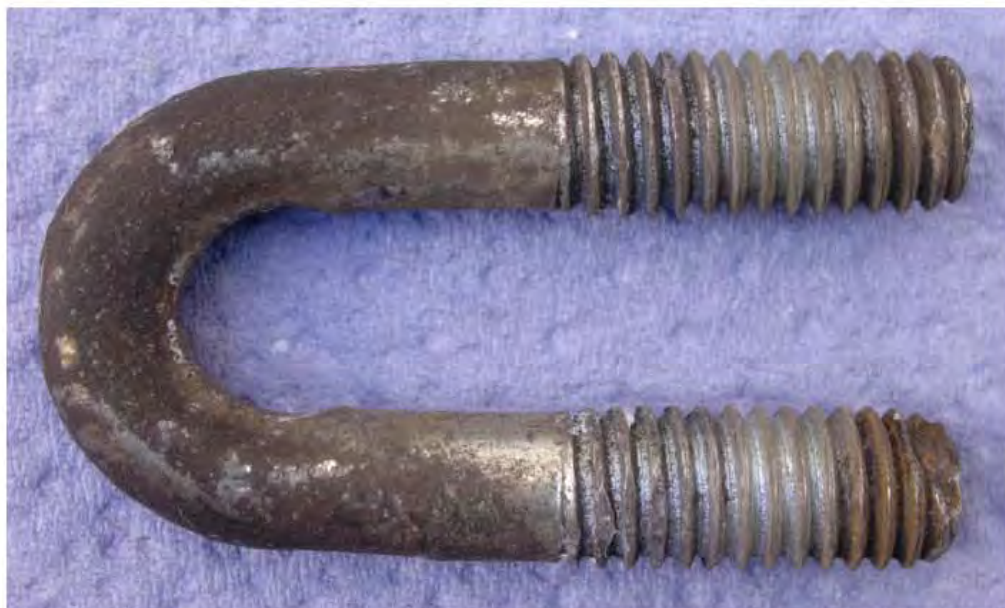
Bild 16: (DSCN5590.JPG) Probe 1, Seilklemme, Klemmbügel, Gewinde M6, Bügelquerschnitt \varnothing 5,2\text{mm}
