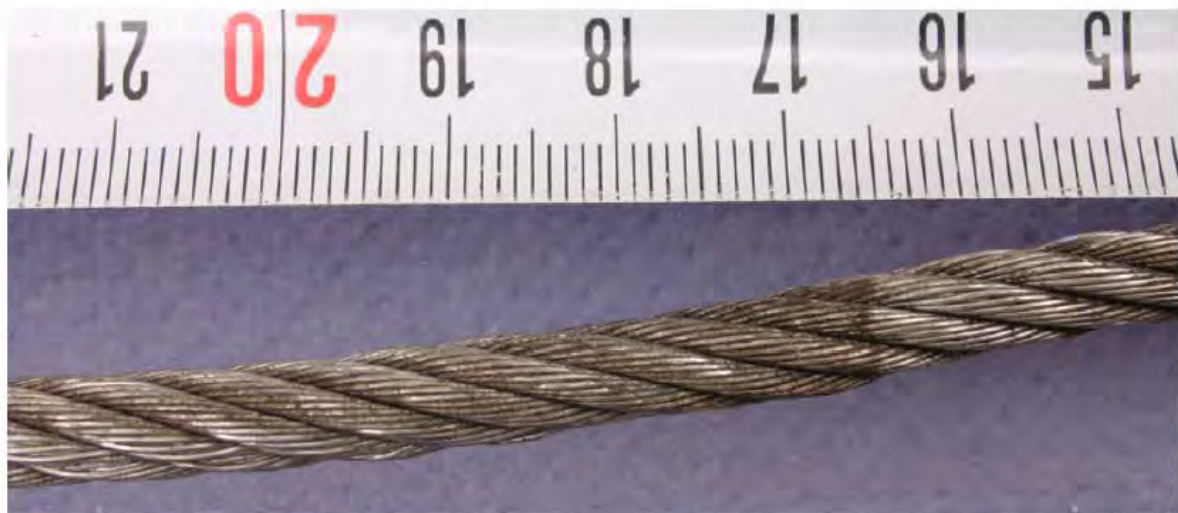
Bild 26: (DSCN5539.JPG) Seilstück 3.1, Zone III (Klemmplatte / Seil). Die Seilklemme 1 befand sich bei etwa 16cm und wurde nach rechts (aus dem Bild) abgezogen. An der Klemmstelle sind kaum Schäden erkennbar.
