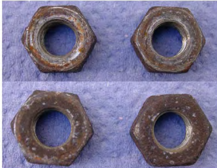
Bild 15: (DSCN5585 / 86.JPG) Probe 1, Seilklemme, 2 Muttern vom Klemmbügel, M6, S=10mm. Im oberen Bild sind die Mutterseiten sichtbar, welche als Druckflächen verwendet waren. Im unteren Bild sind die gegenüberliegenden Seiten aufgenommen.
