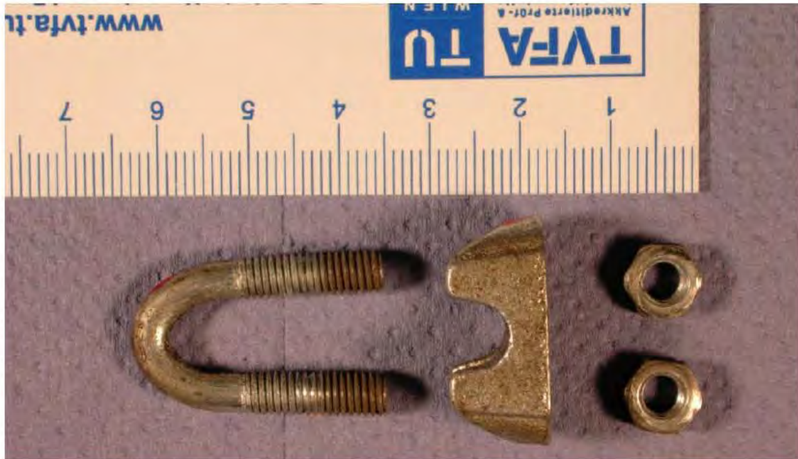
Bild 22: (DSCN5513.JPG) Seilklemme 1 von Probe 3, aufgenommen in zerlegtem Zustand nach dem Zugversuch.
