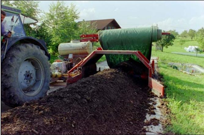
**Abbildung 9-21: Seitlich gezogenes Umsetzgerät mit Vorrichtung zum Auf- und Abwickeln von Kompostvlies**
