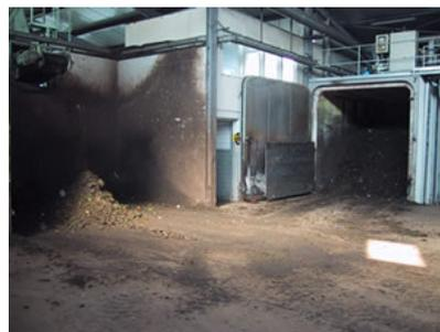
**Abbildung 9-34: Herhof Rottebox (Quelle: Biokomp <http://www.biokomp.de/rotte.html> (2003/07/03))**
