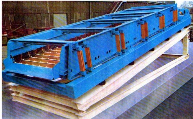
Abbildung 9-39: Funktionsskizze und Foto eines Spannwellensiebs (Quelle: Pretz, 2002)
