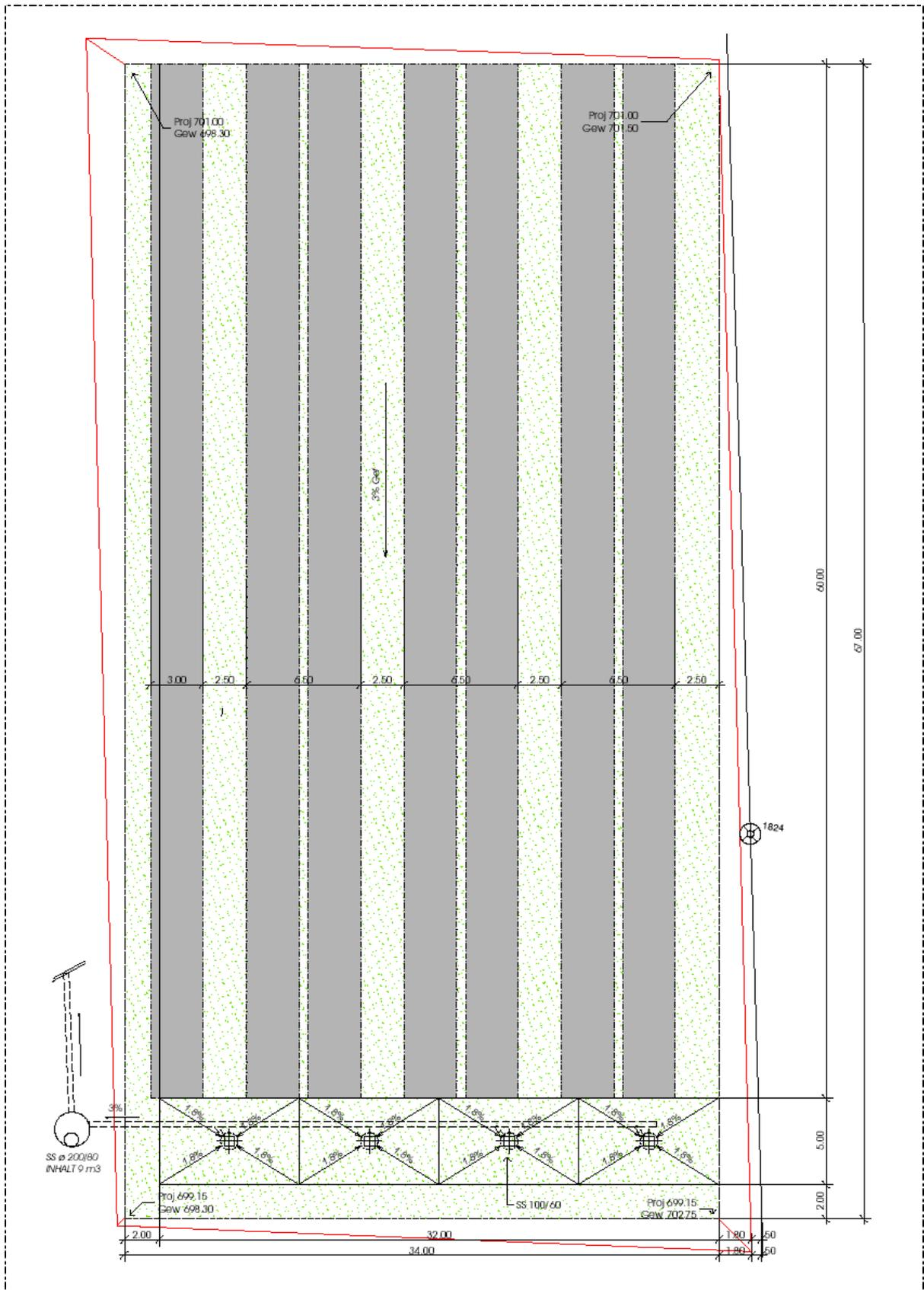
Abbildung 9-20: Beispiel einer einfachen offenen Mietenkompostierungsanlage ohne Belüftung und mit Bearbeitung mittels gezogener Wendemaschine
