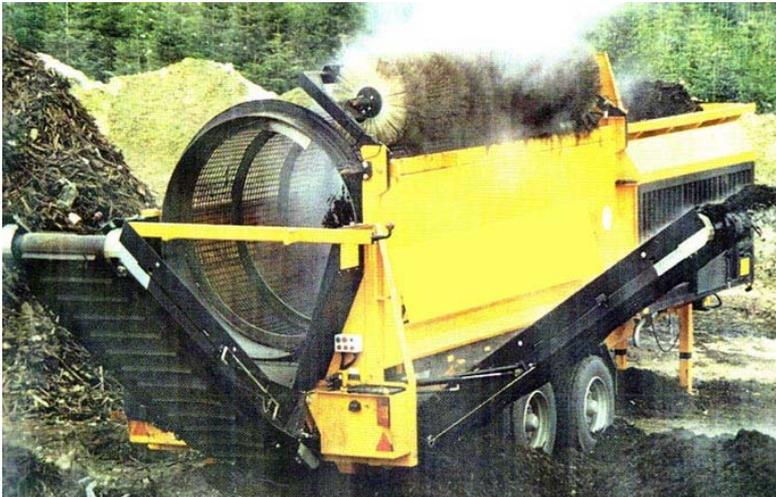
Abbildung 9-38: Funktionsskizze und Foto eines Trommelsiebs (Quelle: Pretz, 2002)
