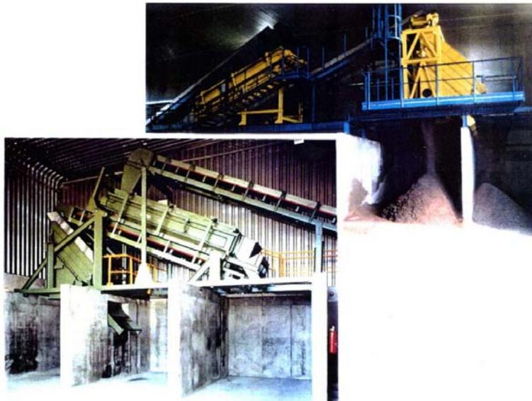
Abbildung 9-43: Prinzip von Hartstoff(Prall)abscheidern (Pretz, 2002)
