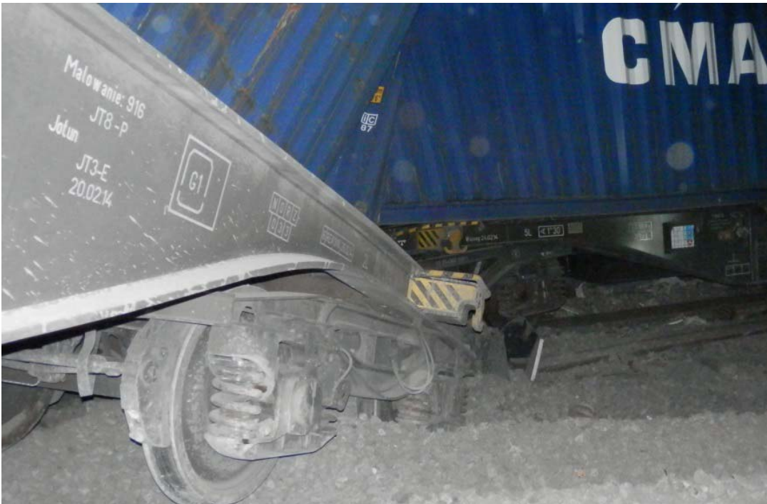
Abbildung 10: Z 43601 – Beschädigte Fahrzeuge im Tunnelbereich (Quelle SUB)
