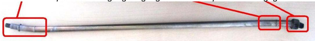
Die Befestigung der Steuerspinne für die Blattverstellung war verbogen. Auch die in Verbindung stehenden Bauteile der Steuerspinne wiesen richtungsgleiche Verformungen auf. Das lässt auf eine einzige Krafteinwirkung (Baumberührung) schließen.
