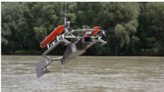
Abbildung 17. BfG-Sammler zur Messung des Geschiebetransports (© IWA/BOKU).
