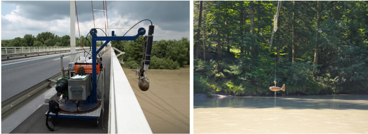
Abbildung 12. Messanhänger mit Schwebstoffentnahmegesetz und ADV (links) und Schwebstoffentnahmegesetz an einer Messeilbahn (© IWA/BOKU).
