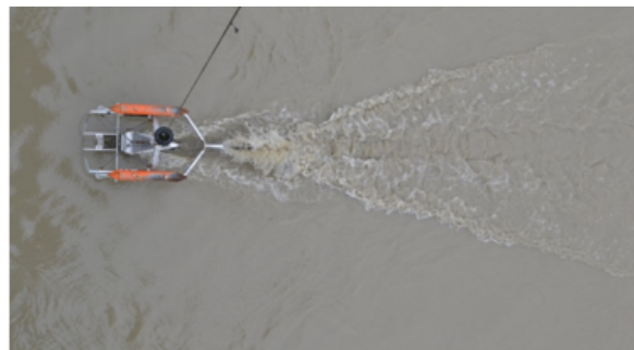
Abbildung 17. BfG-Sammler zur Messung des Geschiebetransports (© IWA/BOKU).
