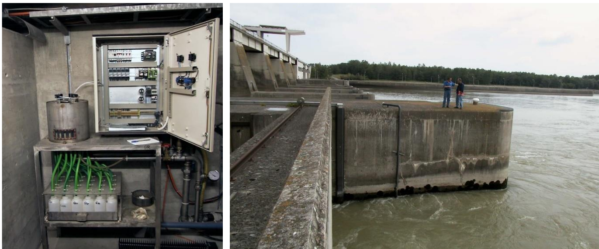
Abbildung 9. Automatisierter Pumpprobennehmer (© VERBUND). Messstelle an einem VERBUND Kraftwerk (© Verbund)
