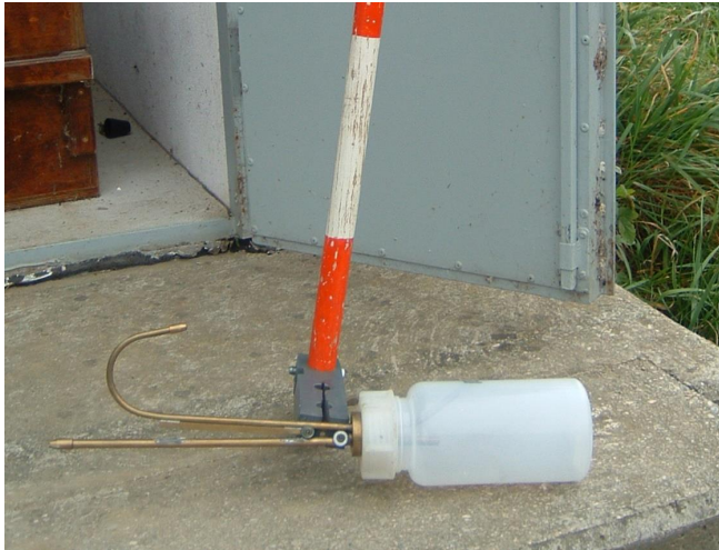
Abbildung 8. Sammler an Teleskopstange mit Einlaufrohr zur Entnahme von Flaschenproben (© BMLFUW 2008, 2017b).
