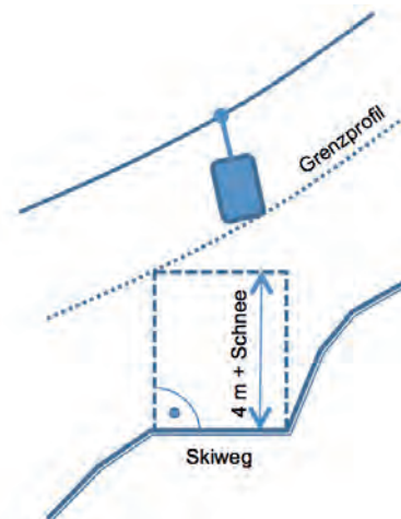
Lichtraumprofil eines Skiweges an der Kreuzung Skiweg mit Seilbahn
