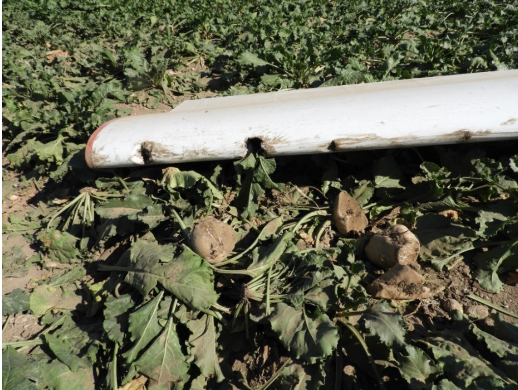
Abbildung 12: Löcher bzw. Einschläge in der Eintrittskante
