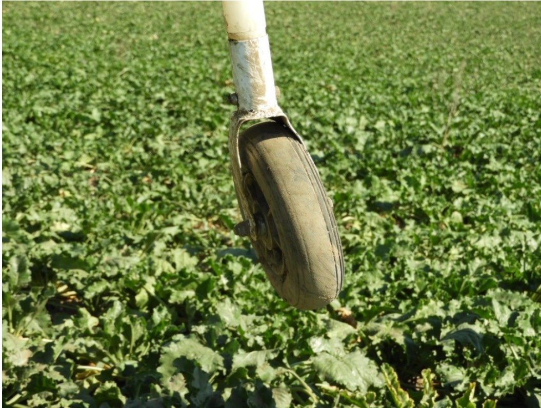
Abbildung 16: verbogener Haltebügel des Stützrades
