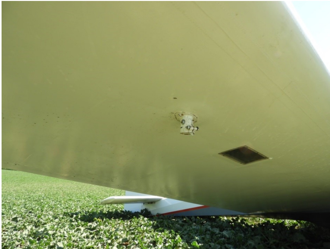
Abbildung 13: fehlendes bzw. abgebrochenes Stützrad
