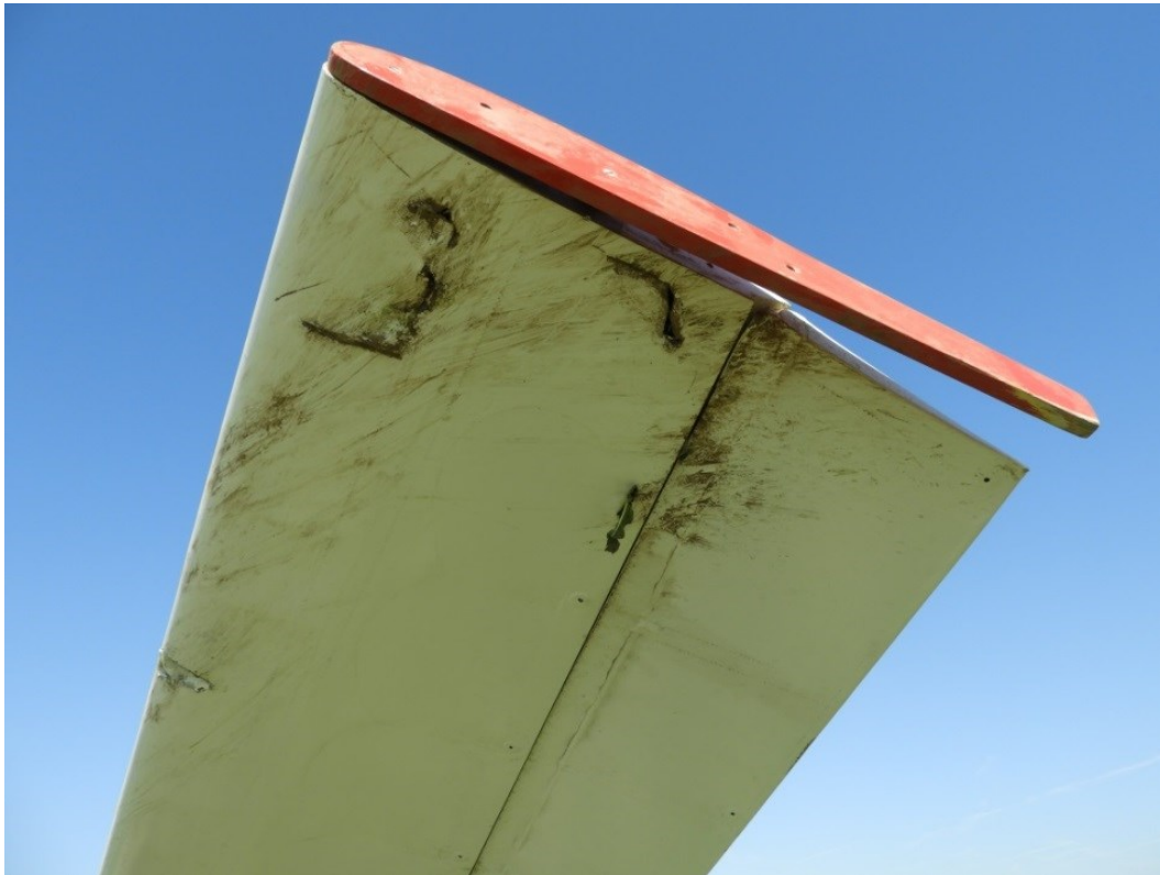
Abbildung 14: beschädigte Bespannung und Randleiste
