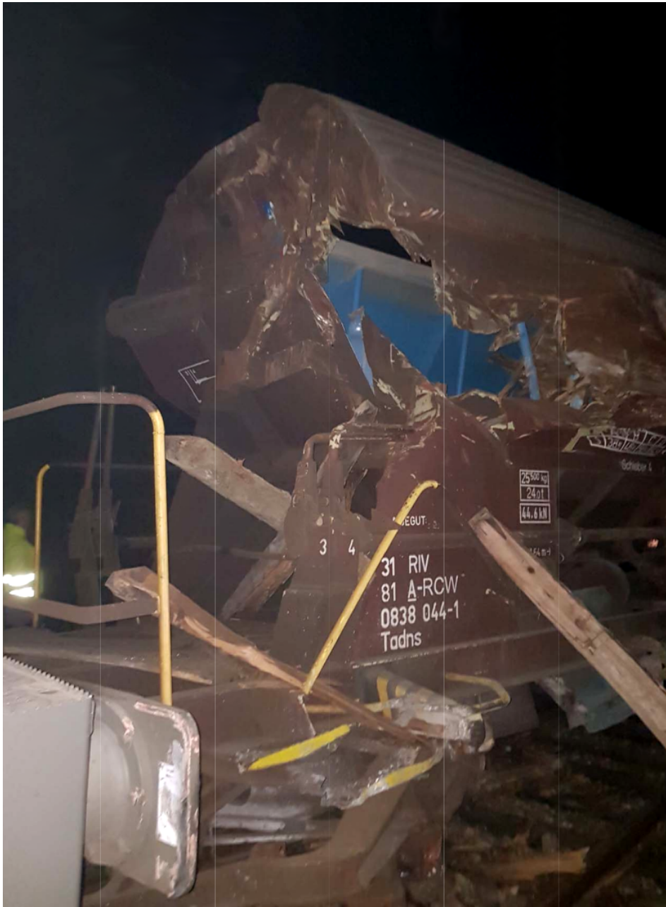
Abbildung 9 Schäden am entgleisten Wagen 1
