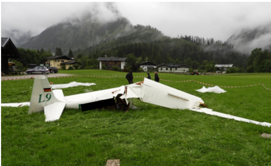
Abbildung 11 Rumpf, Seitenleitwerk und beschädigte Tragflächen
