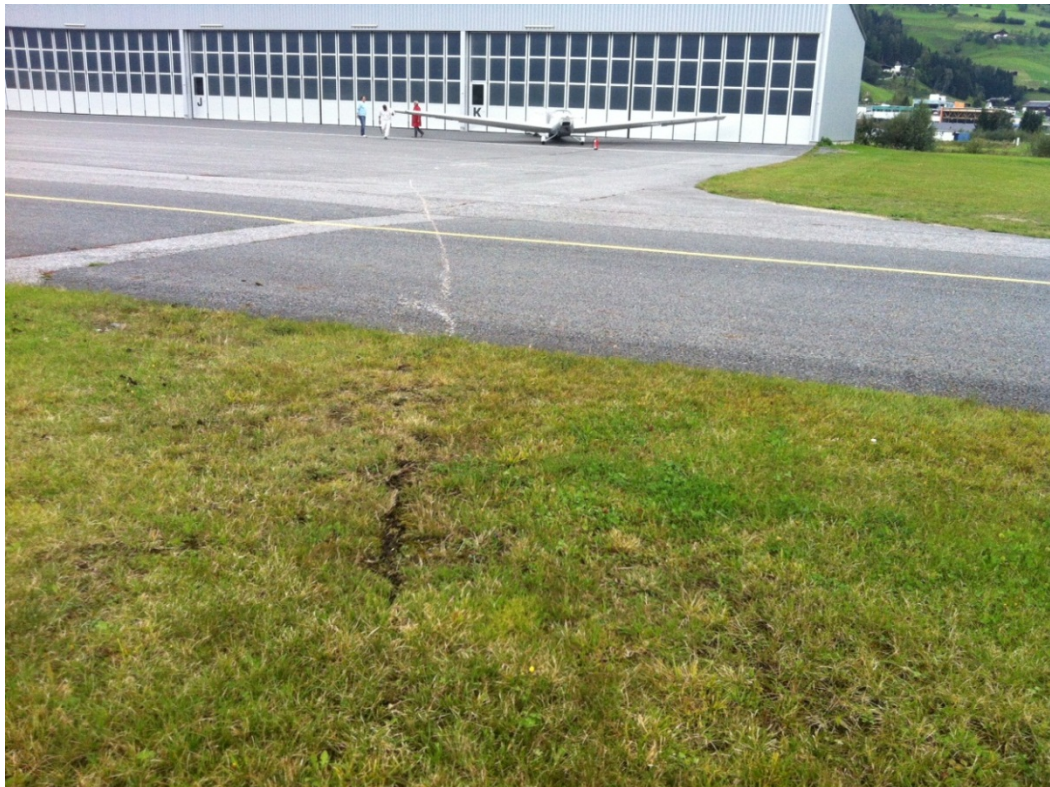
Bild 4: Luftfahrzeug in Endposition vor Hangar 3, Aufschlagsspuren in Wiese und auf Rollweg L
