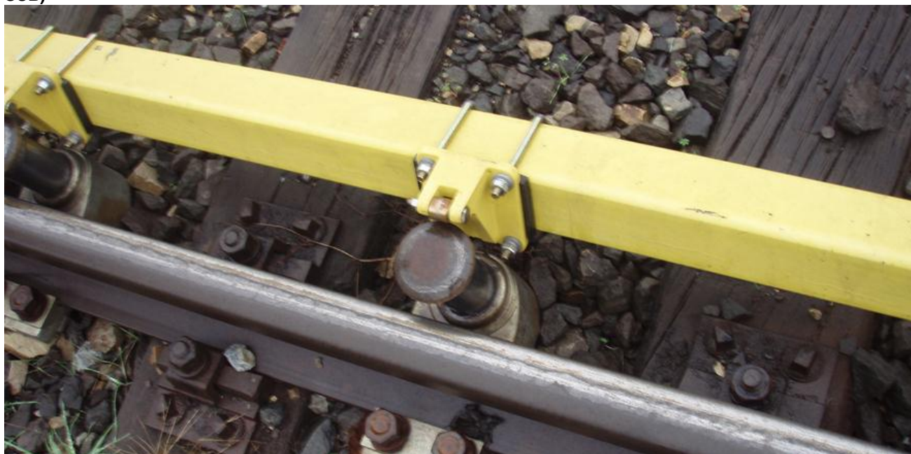
Abbildung 6 Gefälleausgleichsbremse – Detail Retarderbremse Bauart „Dowty“ (Quelle SUB)
