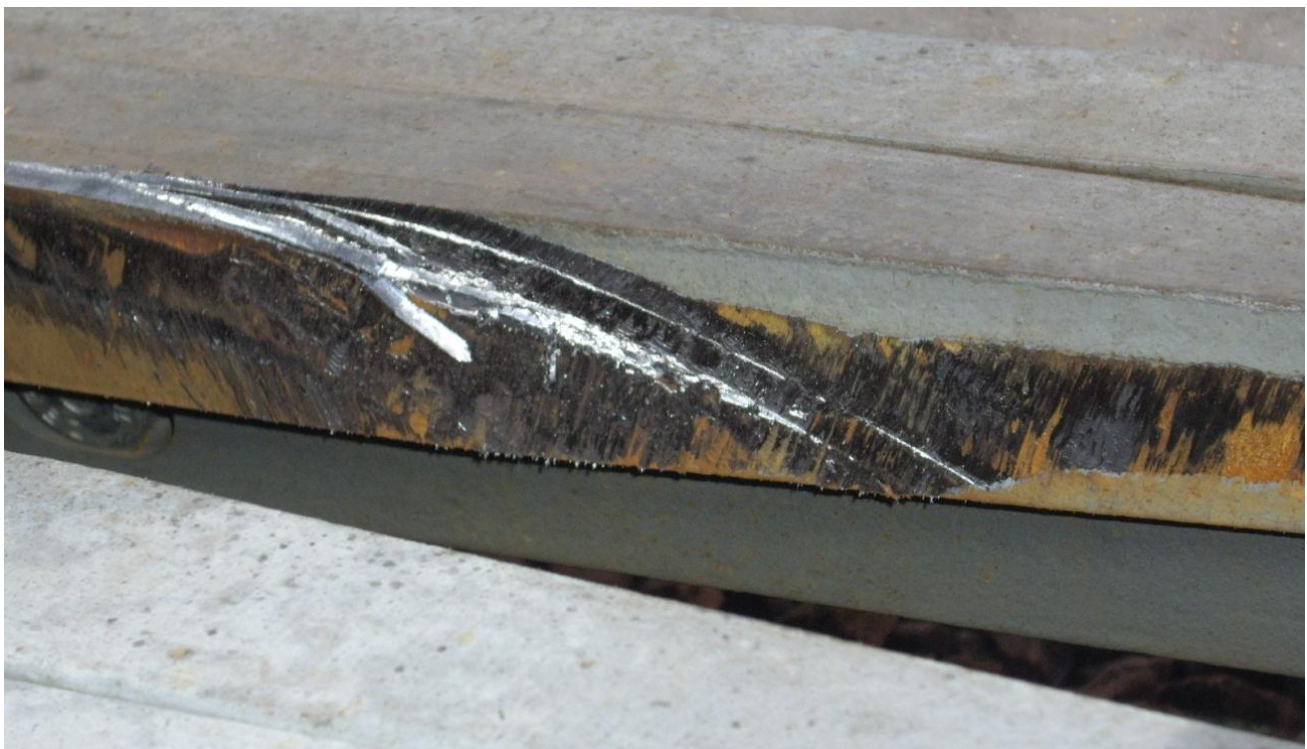
Abbildung 15 Entgleisungsspuren durch eine überwalzte Radlauffläche (Quelle IM)
