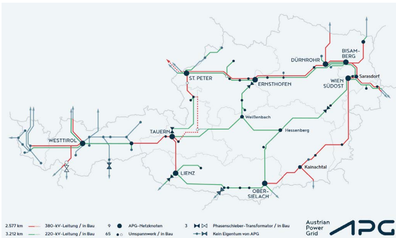
Abbildung 10: Österreichisches Strom- übertragungsnetz, Bild: APG, 2023a
