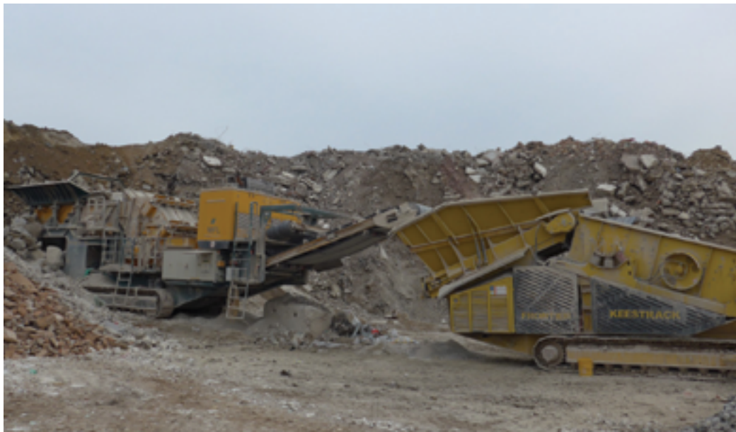
Abbildung 67: Mobile Anlage zur Aufbereitung von mineralischen Baurestmassen
