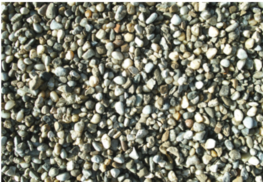
Abbildung 141: Recycling-Baustoff aus Bodenaushubmaterial
