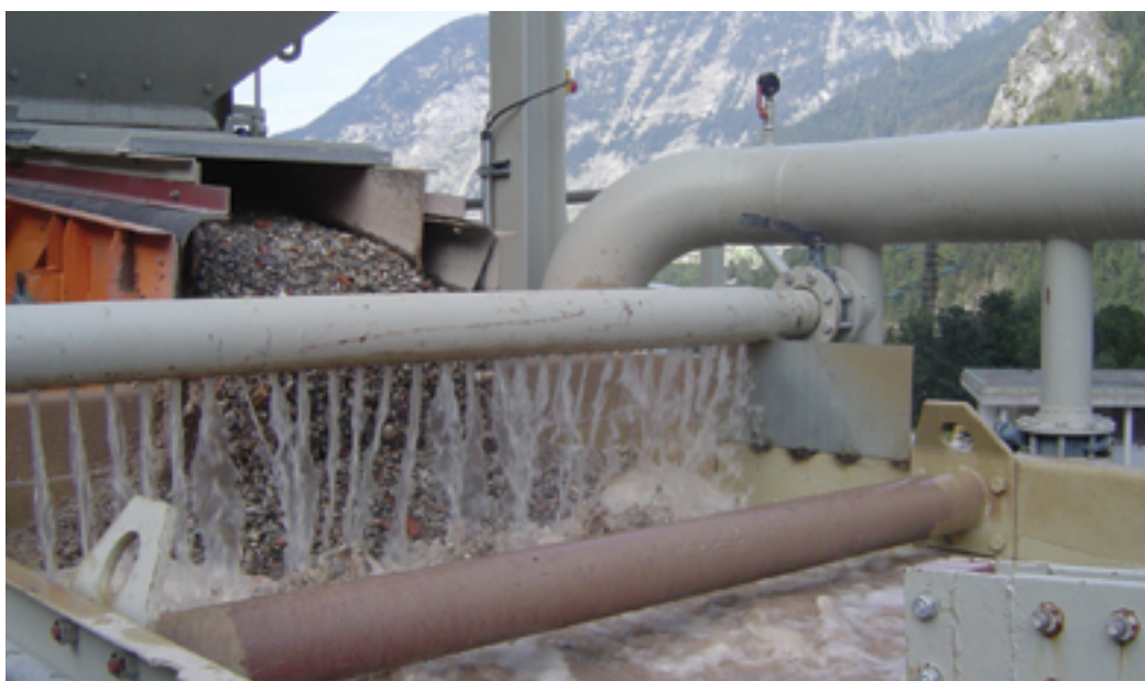
Abbildung 68: Nassaufbereitung von mineralischen Baurestmassen
