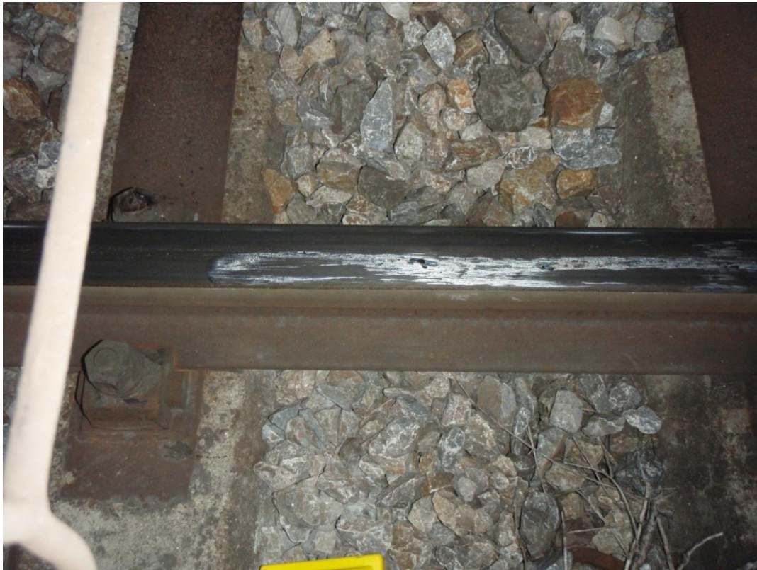
Abbildung 20 Spuren des Hemmschuhs am linken Schienenstrang (3) - Quelle IM
