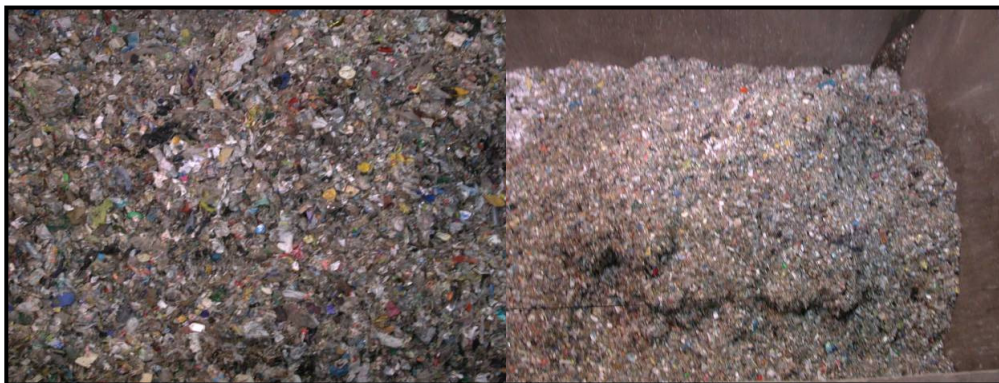
Abbildung 1: Angelieferte heizwertreiche Fraktion (Korngröße: ca. 50 bis 250 mm) aus der Splittinganlage der MA48 (Rinterzelt)
