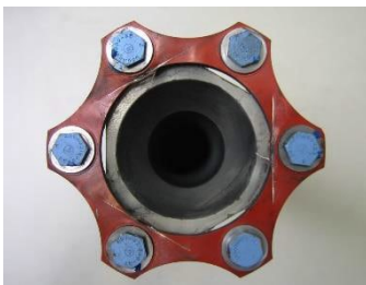
Abbildung 22 Aufprallspuren an der Flexkupplung
