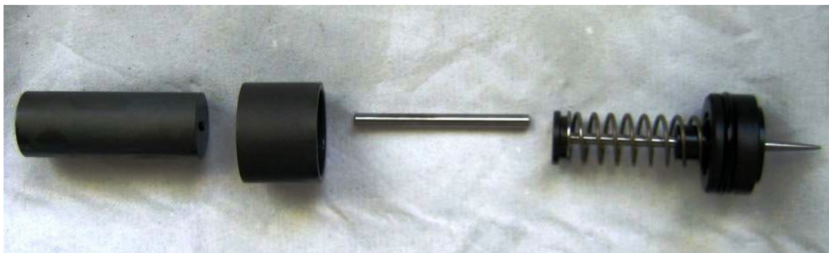
Abbildung 61 Zweiteiliger Arbeitskolben mit Verstellstange und Kraftstoffzufuhrventil
