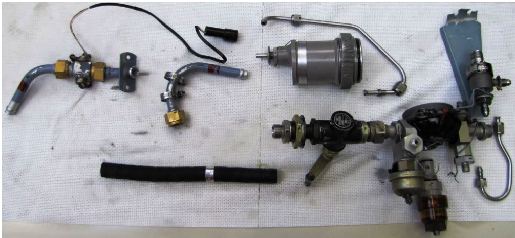
Abbildung 35 Zerlegung der zellenseitigen Filtereinheit
