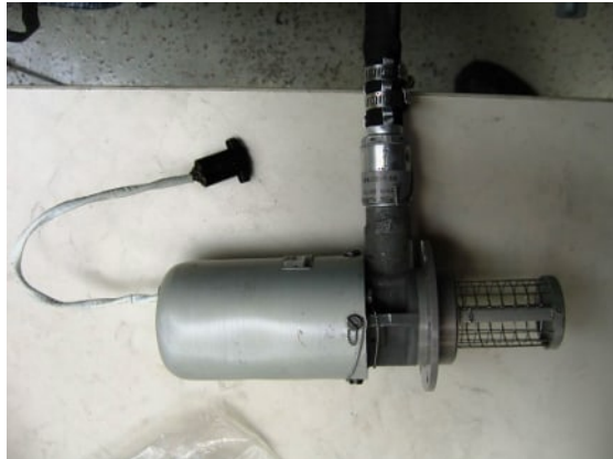
Abbildung 34 ausgebaute Kraftstoffpumpe Nr. 2
