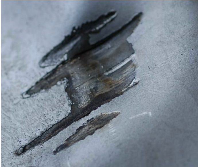
Abbildung 50 Schleifspuren im Front Support Casing
