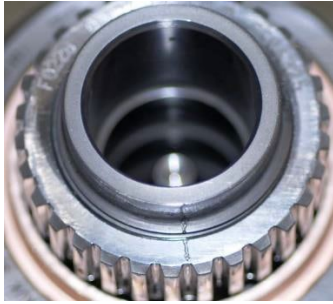
Abbildung 53 Getriebe Eingangswelle mit Positionsmarkierung
