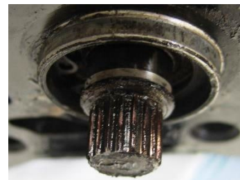
Abbildung 24 Antrieb der Hydraulikpumpe
