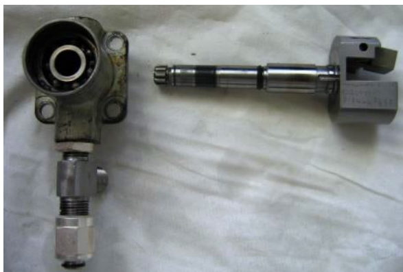
Abbildung 63 N2 Regler mit Fliehkraften
